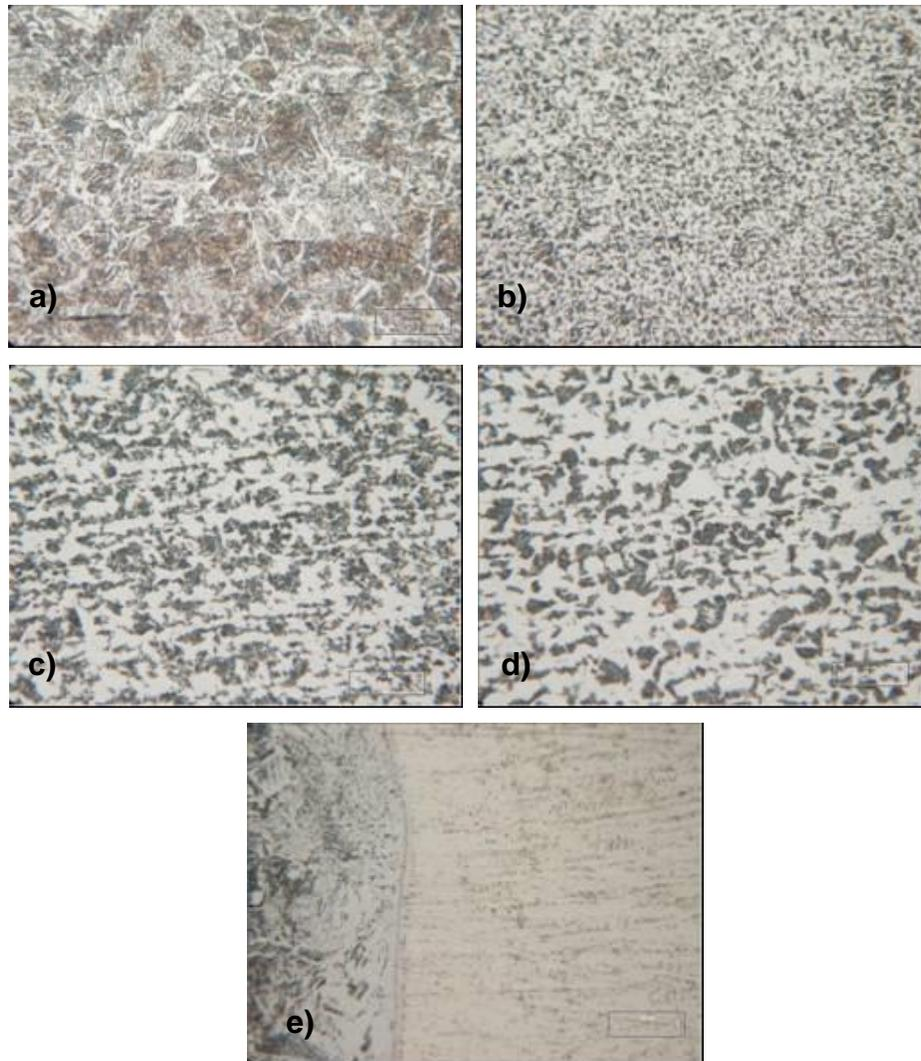
**Figura 4.7. Microestructuras de la unión soldada entre un acero de bajo carbono y un acero inoxidable austenítico con tipo de junta de bisel simple “BS”, amplificación 50, a) zona de grano grueso b) zona de recrystalización o grano fino, c) zona parcialmente transformada, d) zona no afectada e) interfase de la unión**
