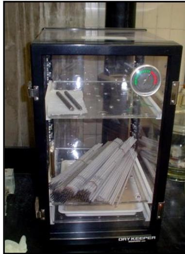
**Figura 3.7. Desecador, (Dry Keeper Sanplatec Corp.)**
