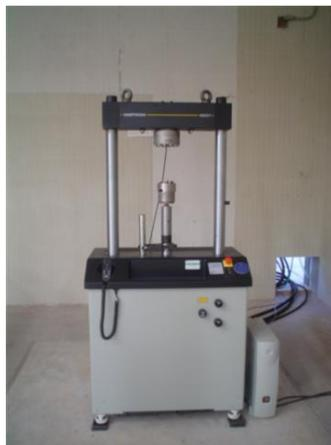
Figura 3.22 Máquina universal INSTRON FAST TRACK, modelo 8801
