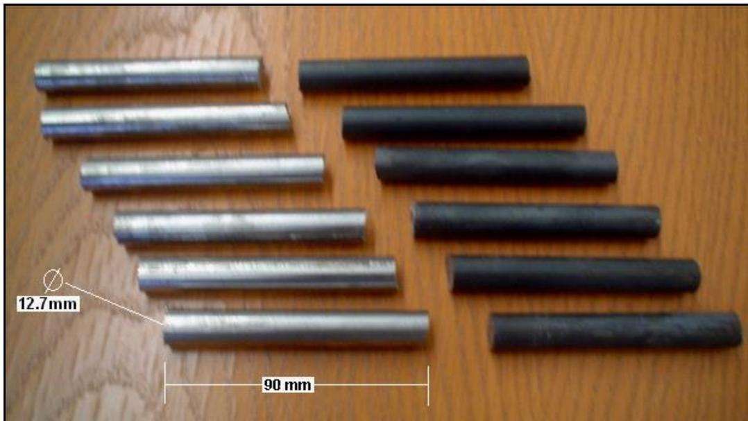
Figura 3.3 Dimensiones de las barras de acero al carbono y acero inoxidable para crear las probetas soldadas
