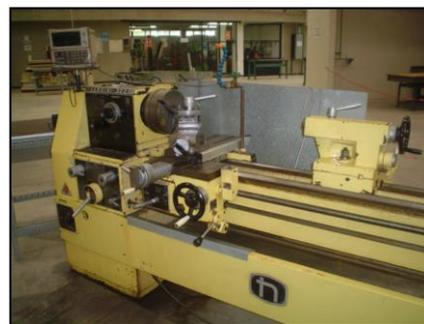
**Figura 3.20 Proceso de maquinado de las probetas en un torno convencional (marca NARDINI-300III)**
