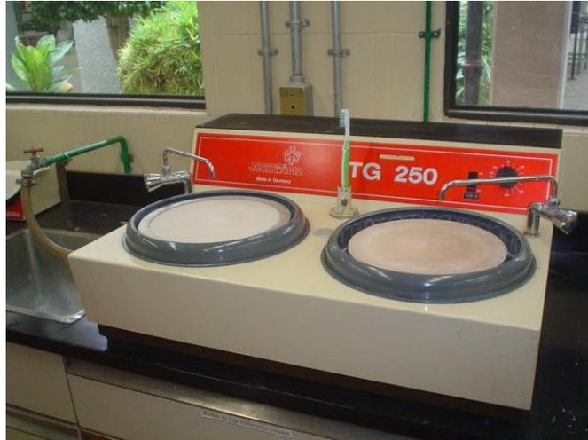
Figura 3.14 Pulidora de mesa de disco doble (marca Jean Wirtz modelo TG-250/2)
