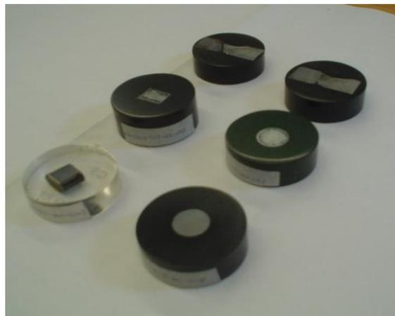
**Figura 3.12 Muestras desmoldadas**
