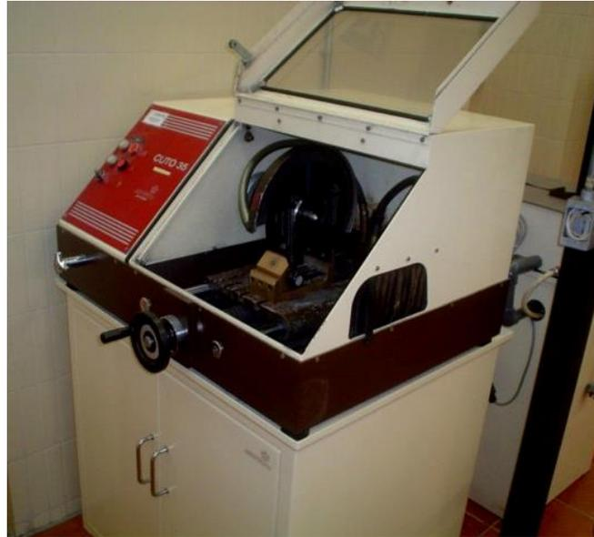
Figura 3.2 Cortadora de disco sumergible (marca Jean Wirtz; modelo Cuto 35)
