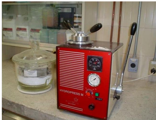
**Figura 3.11 Montadora Hidráulica, Jean Wirtz, modelo Hidropress-M**
