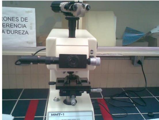
**Figura 3.16 Microdurómetro Knoop Quality High modelo MMT-1**
