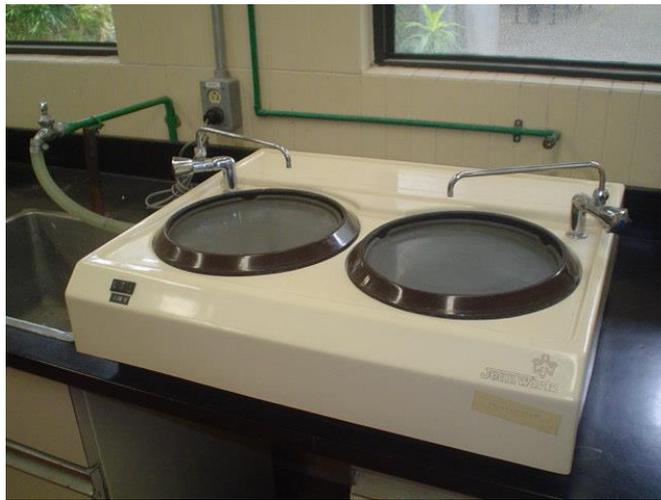
Figura 3.13 Lijadora húmeda de disco doble (marca Jean Wirtz)
