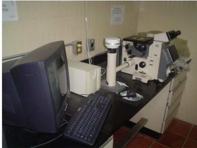
**Figura 3.15** Microscopio óptico (*Olympus de Platina Invertida modelo PMG3*) y analizador de imágenes (*Image-Pro versión 4.5*)
