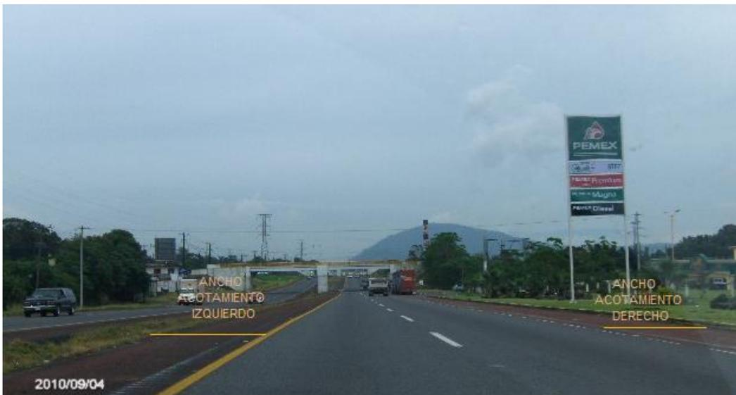
**Figura 2.2 Ancho del acotamiento izquierdo y del acotamiento derecho en una carretera multicarril real.**
