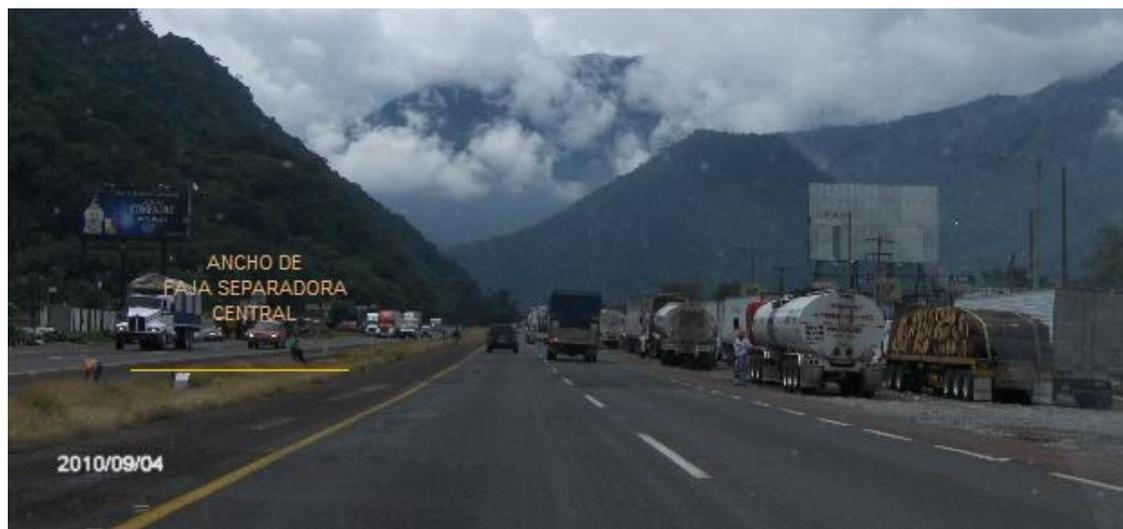
**Figura 2.3 Ancho de la faja separadora central en una carretera multicarril real.**
