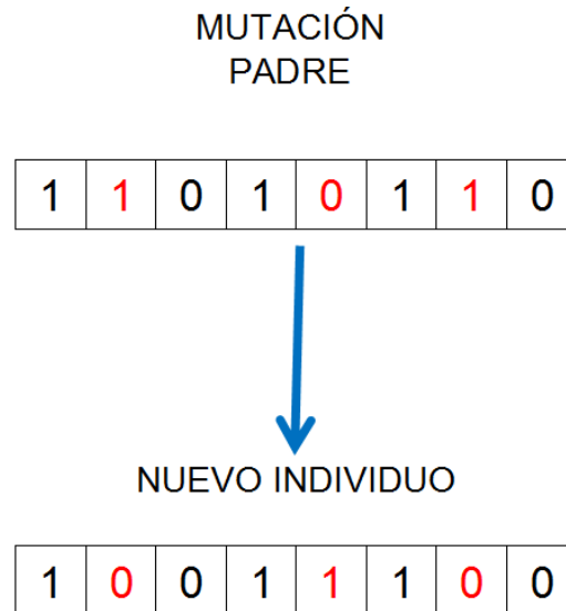
Figura 2.4 Operador de Mutación
