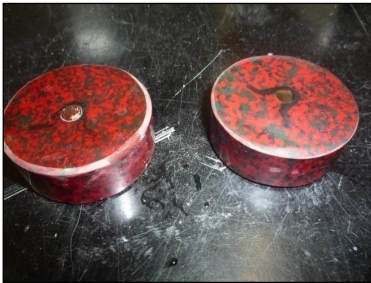
**Figura 3.10 Probetas para medir la dureza Vickers**
