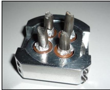
**Figura 3.15 probetas montadas en la base y portaprobetas**
