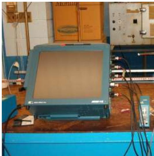
**Figura 2.2 Dispositivo de adquisición de datos Astro Med. Inc. Dash-18**
