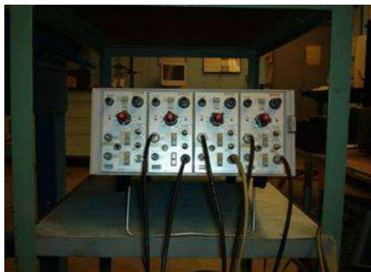
**Figura 2.3 Amplificador Tektronix TM505**
