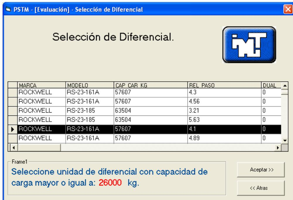
Figura 8.31 Características del diferencial Rockwell modelo RS 23 161 A capacidad de carga de 57 607 kg y relación de paso 4.10:1
