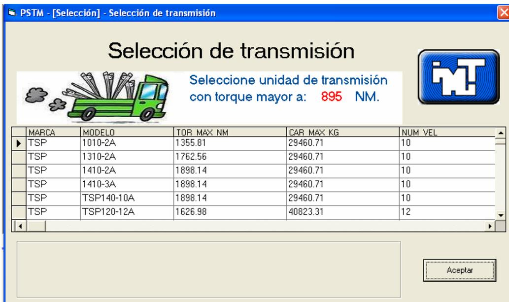
Figura 8.24 Modelos de transmisión para el nuevo tren motriz. La transmisión seleccionada es la TSP 1010-2A con capacidad de carga de 29 460 kilogramos.
