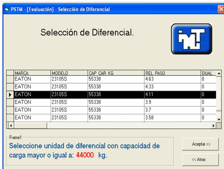
Figura 8.3 Diferencial marca EATON modelo 23105S, con capacidad de carga de 55 338 kg y relación de paso de 4.11.
