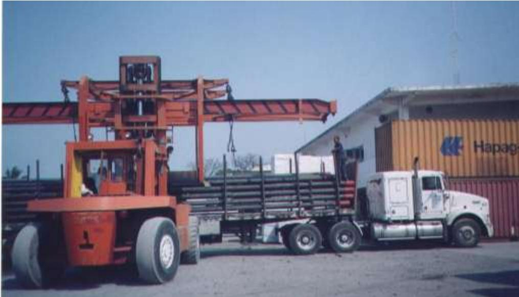
**Figura 6.2 Tractocamión de prueba Clase T3-S2, para la evaluación del tren motriz, en la ruta del Puerto de Veracruz a la Cd. de Perote, Ver. - Puerto de Veracruz (ICATVER, EI 0206)**
