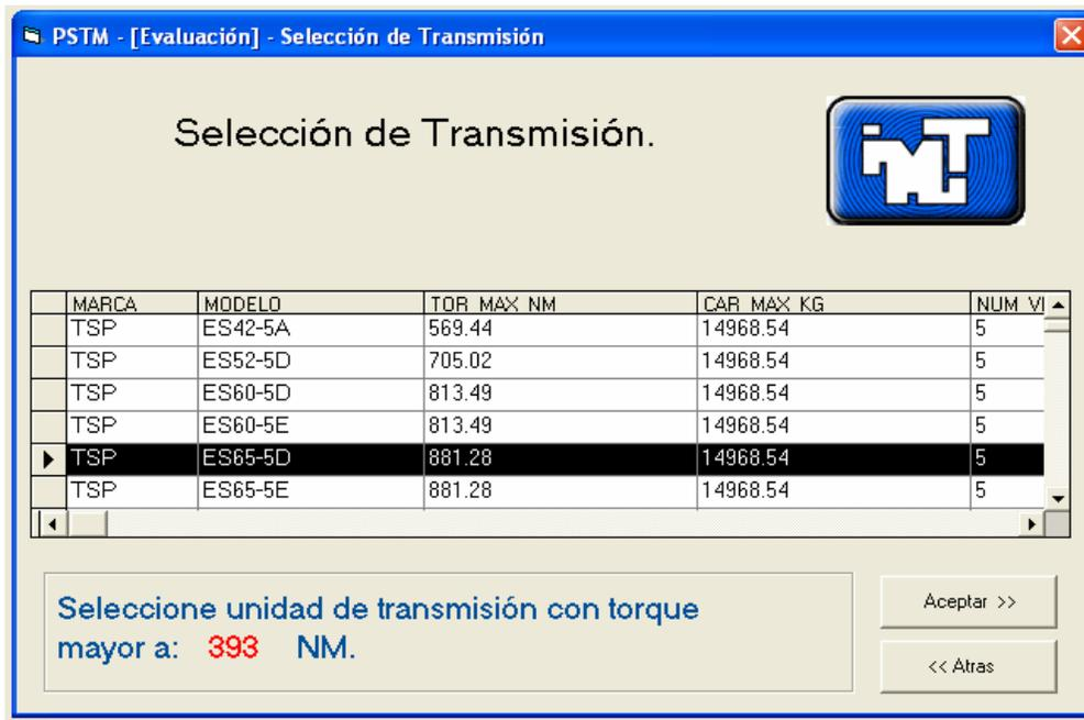
Figura 8.15 Características de la transmisión ES65-5D, proporcionando un torque máximo de 881,28 Nm
