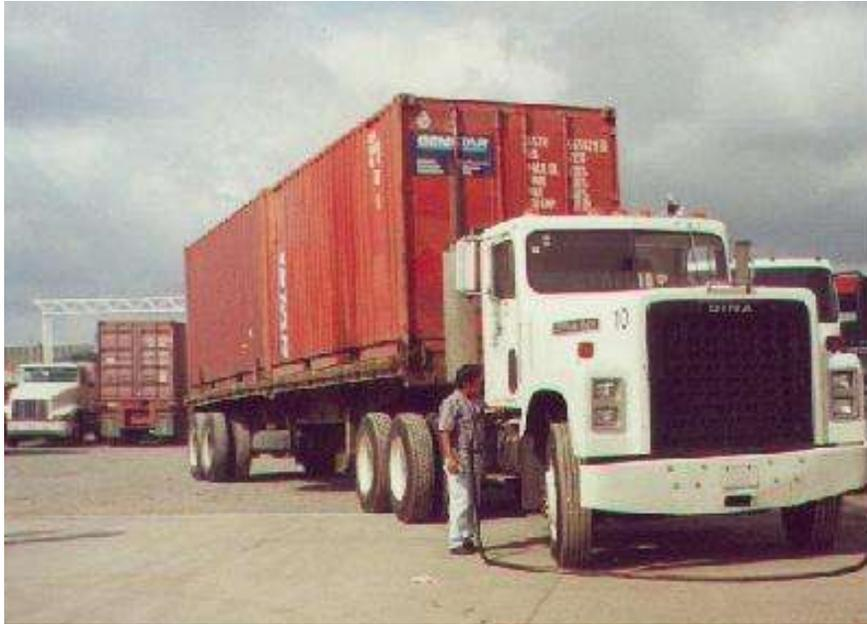
**Figura 6.1 Tractocamión de prueba Clase T3-S2, para la evaluación del tren motriz, en la ruta del Puerto de Veracruz a la Cd. de Perote, Ver. - Puerto de Veracruz, distancia del recorrido 324 km (ICATVER, EI 0206)**
