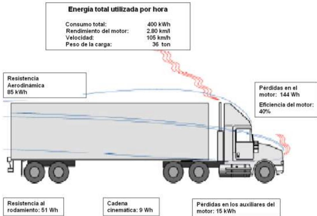
**Figura 3.1 Diagnóstico de la energía utilizada en un VSP en una combinación tractor-semirremolque en una carretera sin pendiente, con velocidad de operación de 105 km/h y con un peso de 36 toneladas, utilizando la energía de 96 kW-h para mover la carga (Duleep, 2007).**
