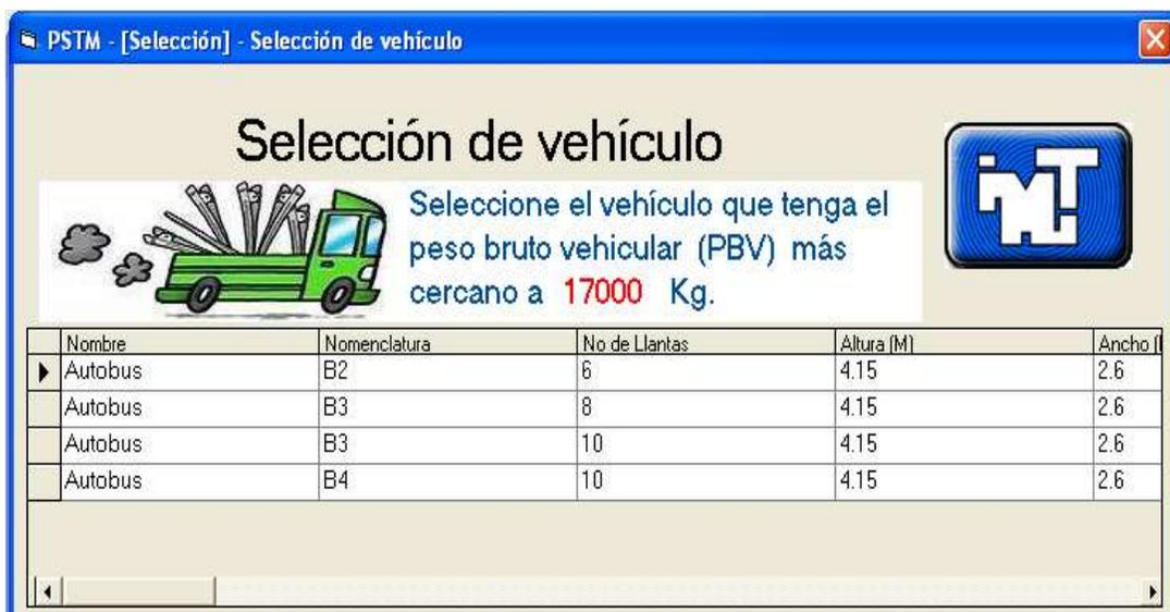
Figura 8.21 Autobús B2 de dos ejes y seis llantas, con altura de 4.15 m y ancho de 2.6 m de acuerdo con la normatividad establecida (SCT, 2008)
