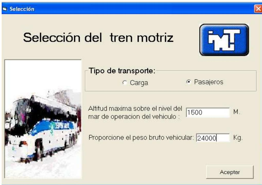
Figura 8.35 Características para la selección del tren motriz del autobús B3, considerando una altitud sobre el nivel del mar de la Cd. de Aguascalientes de 1500 m y el PBV de 24 toneladas.
