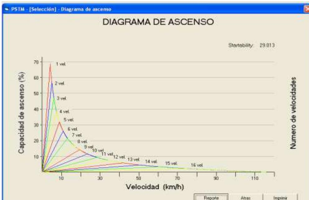
Figura 8.12 Diagrama de capacidad de ascenso del tren motriz del vehículo T3-S2, con motor N14-370E, transmisión TSP0175-16MEGA, paso de diferencial 4.11 y llantas 11R24.5.
