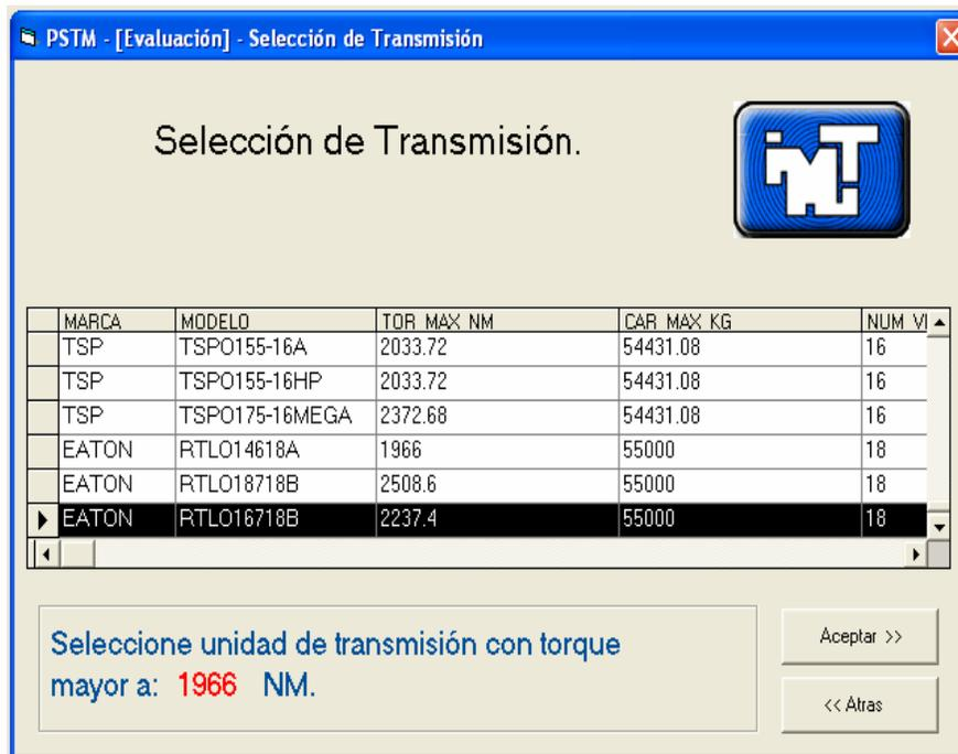
Figura 8.2 Transmisión marca EATON modelo RTLO16718B, con torque máximo de 2237.4 Nm, con capacidad de carga de 55 000 kg y 18 velocidades.
