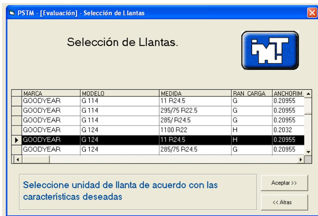
Figura 8.32 Características de la llanta Goodyear modelo G124, con medidas 11R24.5
