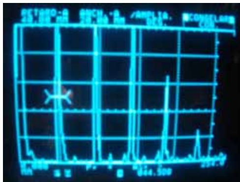
a) Reflexiones de pared posterior para tamaño de grano ASTM 8
