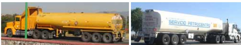
b) Vehículos autotanque del tipo articulado con variación en la geometría y capacidad del contenedor (T3S3)
