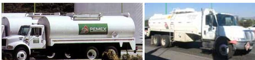
a) Vehículos autotanque del tipo C3 con contenedor de 20 mil litros
