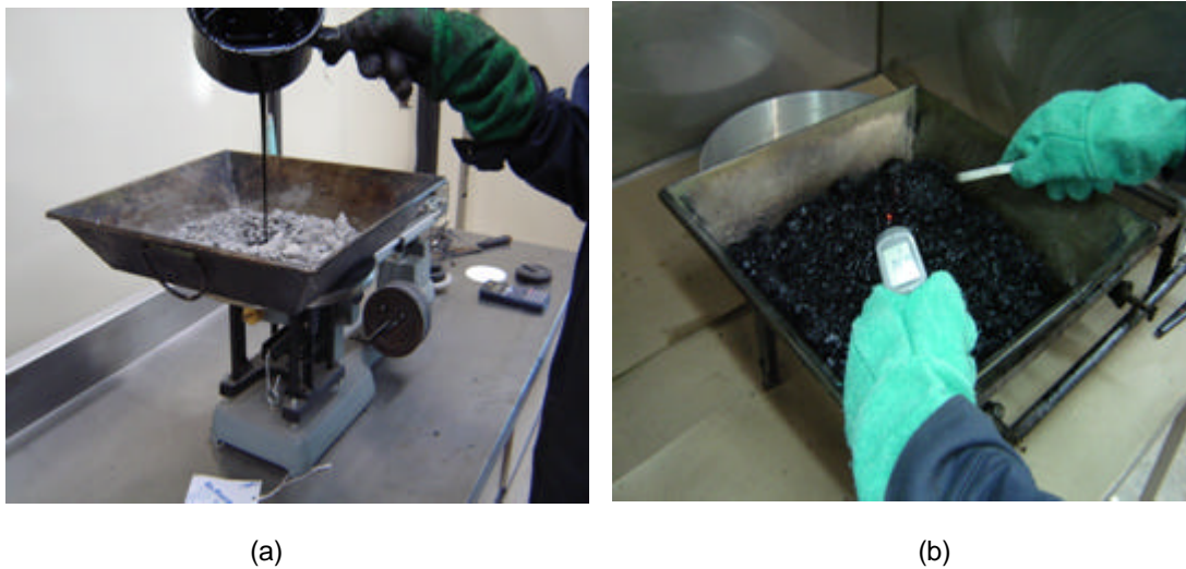
Figura 3.6 Elaboración de la mezcla asfáltica
