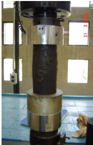
Figura 4.7 Probeta después de la prueba de compresión axial
