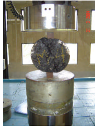
Figura 4.11 Probeta después del ensayo
