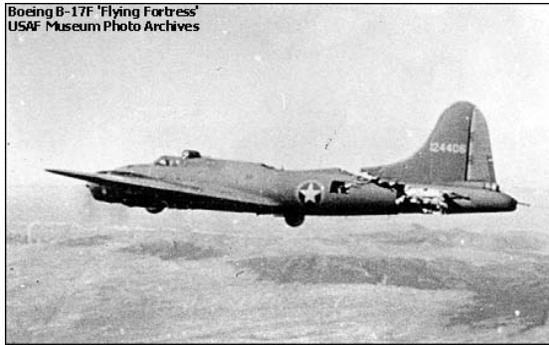
a) Bombardero B-17F en vuelo después de una colisión en el aire
