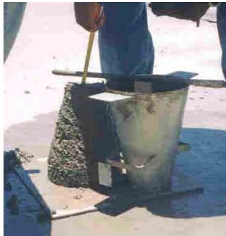
Figuras 3.7 **Pruebas de revenimiento de los concretos durante su fabricación**
