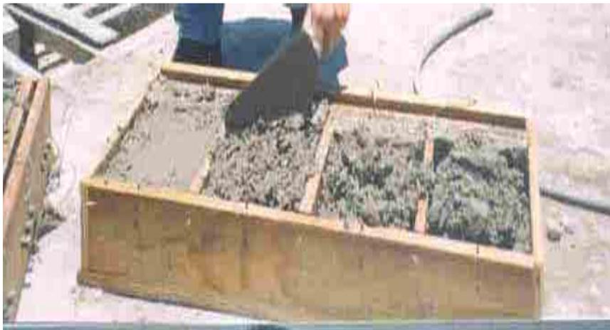
**Figura 3.6 Colocación de la porción de concreto con cloruros**
