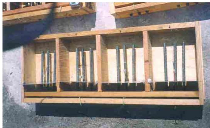
**Figura 3.3 Molde terminado mostrando las tres barras de refuerzo, el electrodo de referencia interno de titanio y la placa de acero galvanizado para separar las zonas con y sin cloruros**
