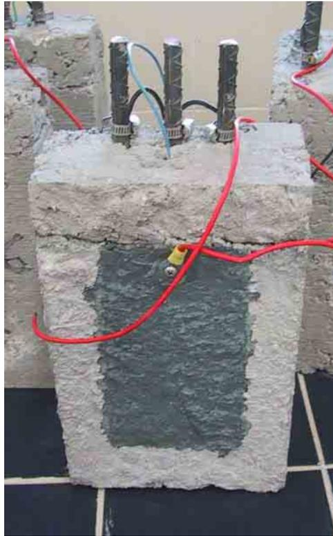
Figura 3.10 **Prisma de concreto listo para ser colocado en la cámara de humedad controlada. Nótese que las tres barras de refuerzo fueron interconectadas para formar un solo elemento por proteger**
