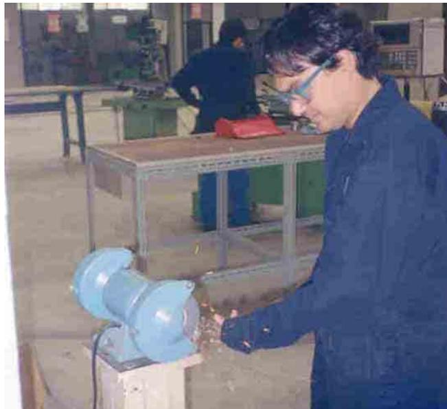
Figura 3.4 **Cabeceo de varillas utilizando piedra de esmeril de banco**
