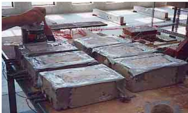
Figura 3.9 **Aplicación del polímero sobre una de las superficies de los prismas de concreto utilizando una brocha de cerdas naturales**
