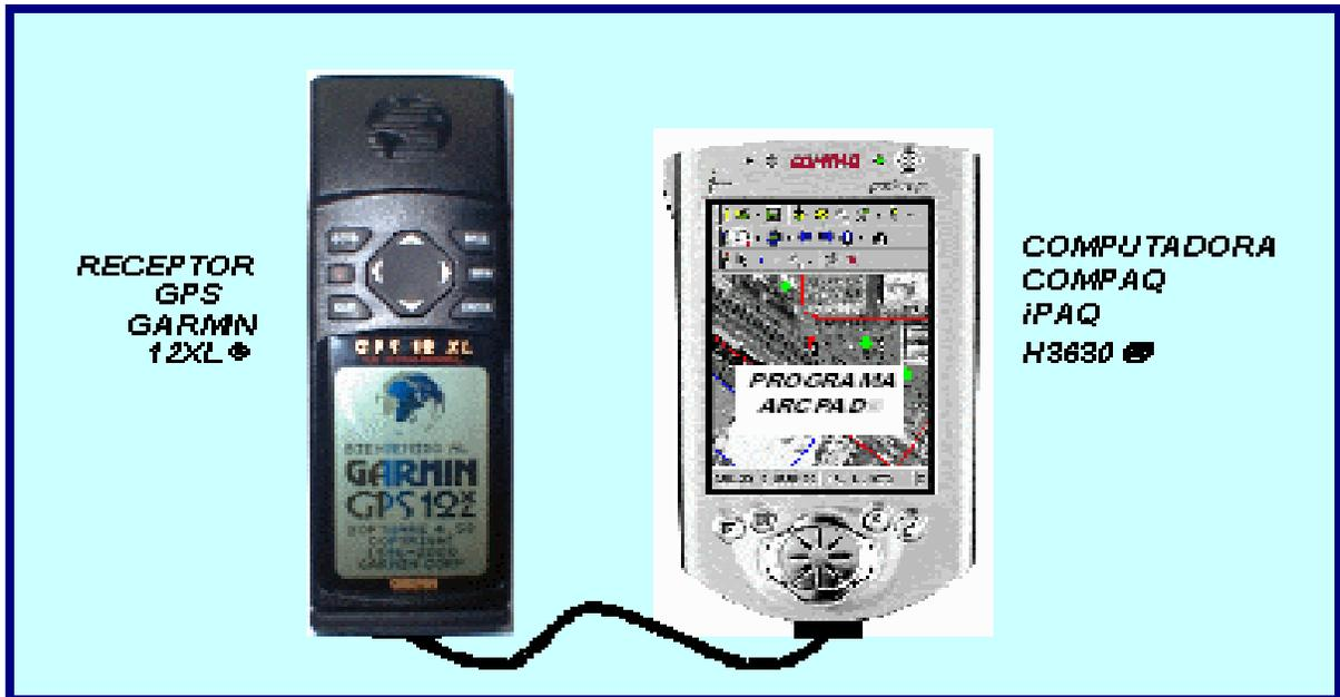
Figura 1.7 Ejemplo de SIG portátil con interfaz de operación con receptor GPS, (ArcPad de ESRI con Garmin 12XL).
