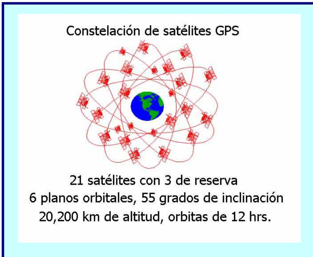
Los satélites de GPS se diferencian por medio de un ruido específico en su señal, de modo que el receptor pueda identificarlos, dicho identificador se conoce como PRN (Pseudo Random Noise /Falso Ruido Aleatorio) y con este identificador son reportados en las pantallas de los receptores cuando se capta su señal; en la bibliografía es usual que se indiquen con las siglas SV (Space Vehicle /Vehículo Espacial).
