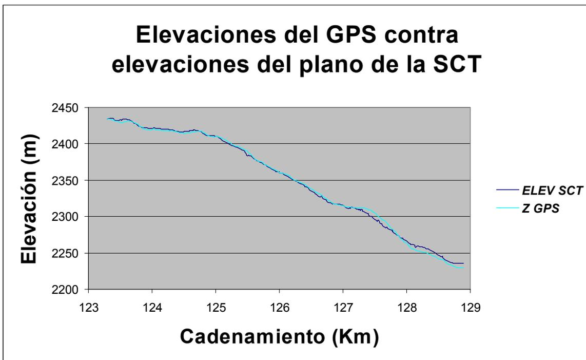
Figura 3.17 Perfiles verticales del inventario de la S.C.T. y del levantamiento con GPS. Segmento km 123+300 a 128+820
