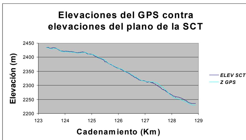
Figura 4 Perfiles verticales del inventario de la S.C.T. y del levantamiento con GPS. Segmento km 123+300 a 128+820
