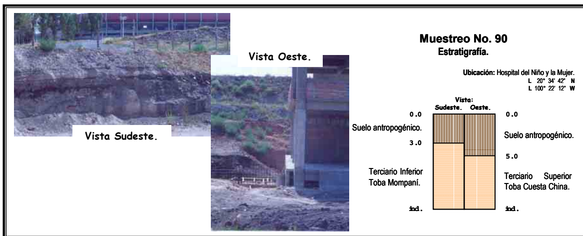
Figura 3.30 Banco relleno con suelos antropogénicos y la construcción de un inmueble.
