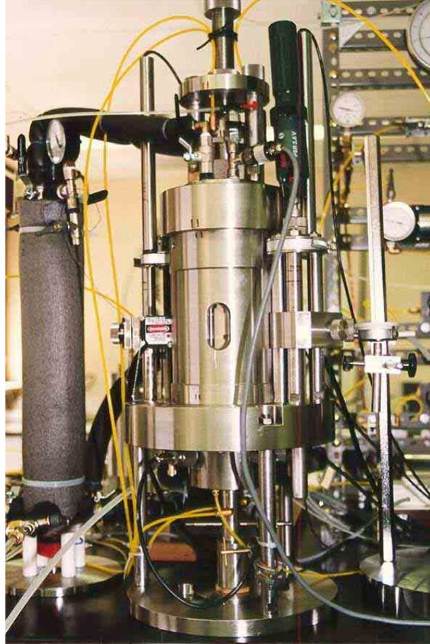
Figura 2.20 Foto de la célula triaxial con control de succión (Romero, 1999; Barrera, 2002).
