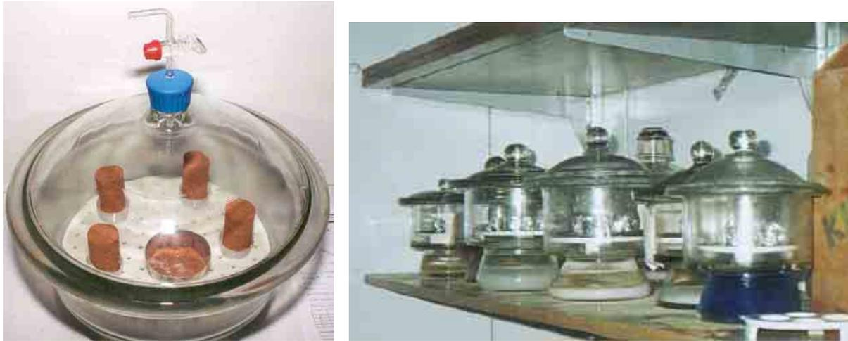
Figura 2.8b Transferencia de vapor asociada a la succión total con disoluciones salinas o ácidas. Probetas bajo atmósfera y humedad relativa impuesta por el procedimiento básico de difusión.
