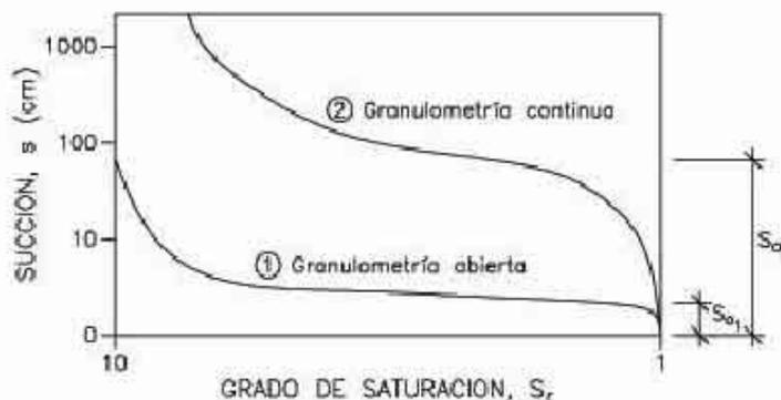
Figura 3.3 Curvas de retención–esquemas.
