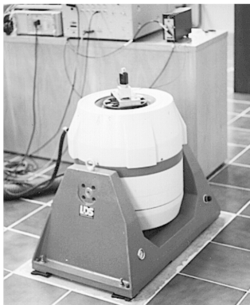
Figura 26. Mesa vibratoria del sistema generador de vibraciones Ling Dynamic System.
