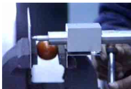
Figura 28. Dispositivo para medir deformación diametral en tomate bajo carga de compresión.
