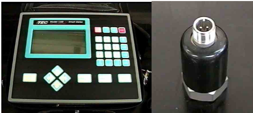
Figura 13. Sistema colector analizador de vibraciones portátil marca TEC, modelo VLF 1330 "Smart Meter" y transductor de aceleración.
