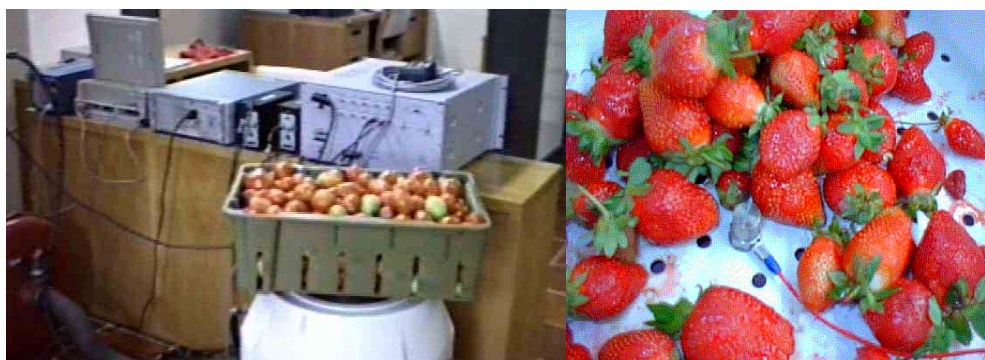
Figura 27. Pruebas de vibración en laboratorio para tomate a granel y detalle de la colocación de un acelerómetro sobre el contenedor de fresa.
