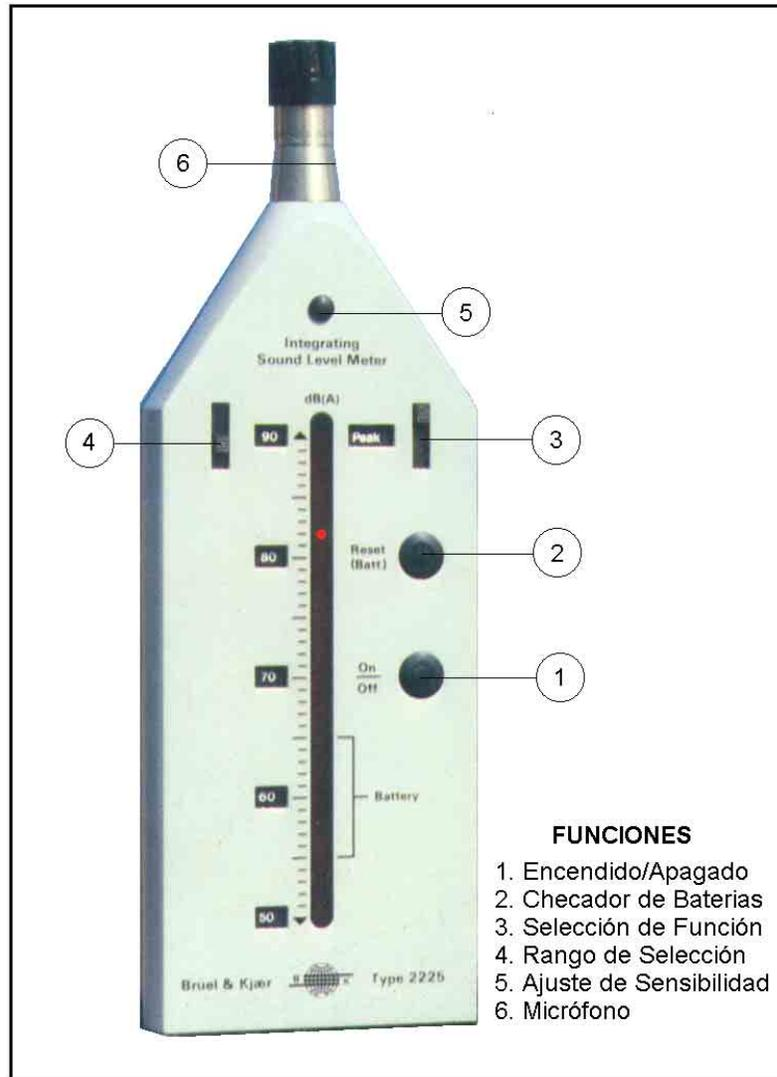
Figura 6.1 **Sonómetro de Precisión marca Brüel & Kjær modelo 2225**
