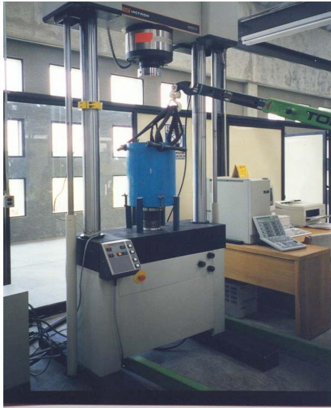
**Figura 2.5 Equipo Servohidráulico INSTRON serie 8503 con probeta de prueba**
