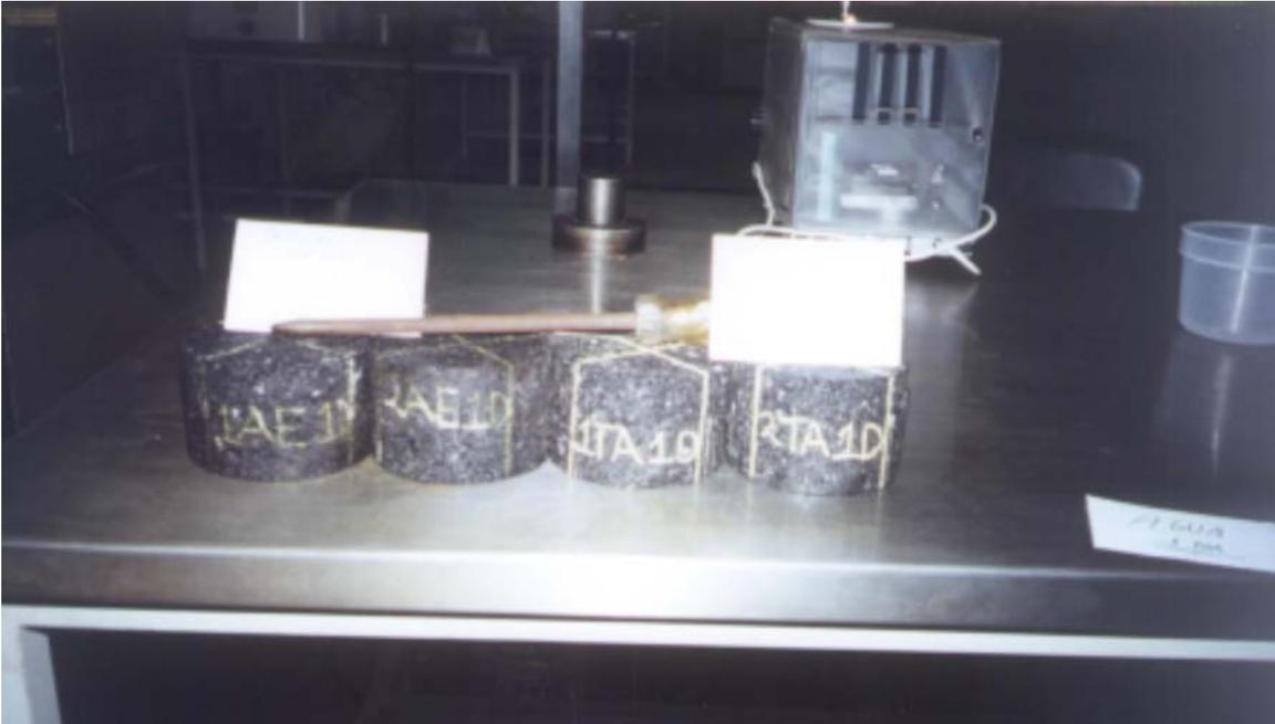
**Figura 5.7-1 Apariencia que mostraron las probetas expuestas en agua al concluir el proceso de exposición a 24 hrs.**
