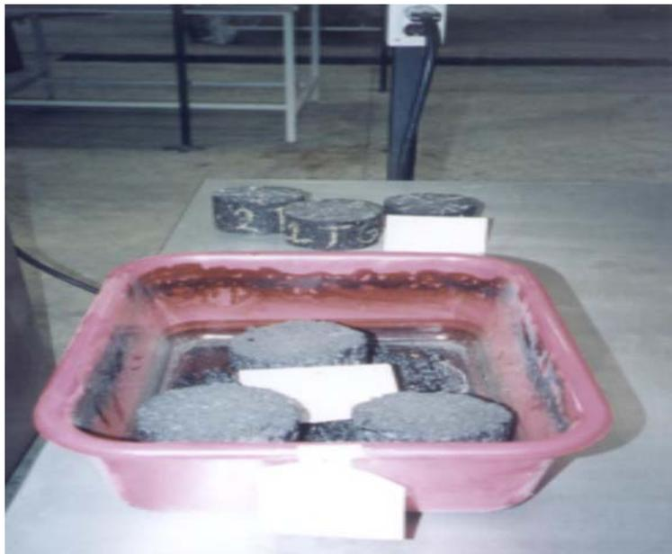
**Figura 4.5-7 Lotes de tres Probetas tanto Expuestas como Testigos para ser ensayadas a tensión indirecta.**
