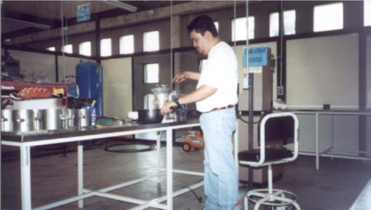
*Figura 4.3- 7 Proceso de vaciado de la mezcla para proceder a su compactación por método estático.*
