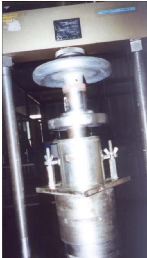
**Figura 4.3- 8 Proceso de elaboración de las probetas por método estático empleando la máquina de compresión mecánica Versa Tester.**
