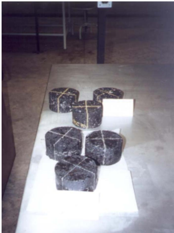
**Figura 5.6-3 Impresión que se tiene de las probetas expuestas en sosa cáustica después de concluir el proceso de exposición a 7 días.**
