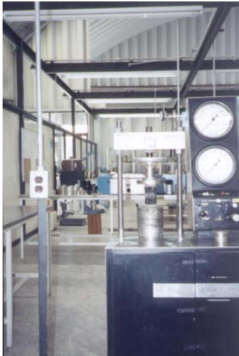
**Figura 4.3-10 Máquina de compresión mecánica Versa Tester.**
