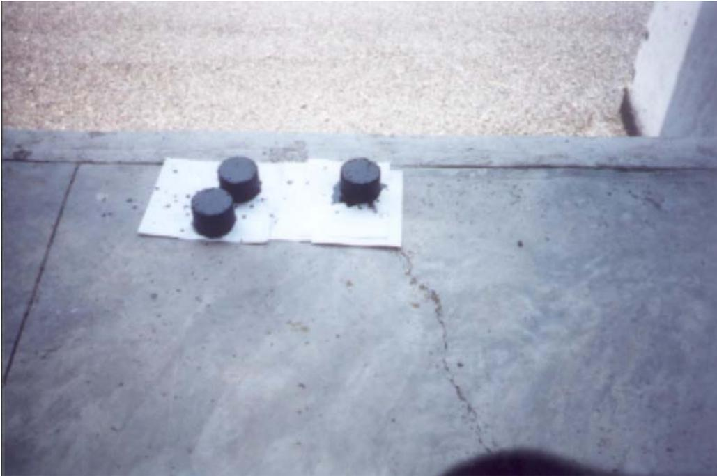
**Figura 5.3-2 Impresión que se tiene de las probetas expuestas en ácido sulfúrico por 7 días.**
