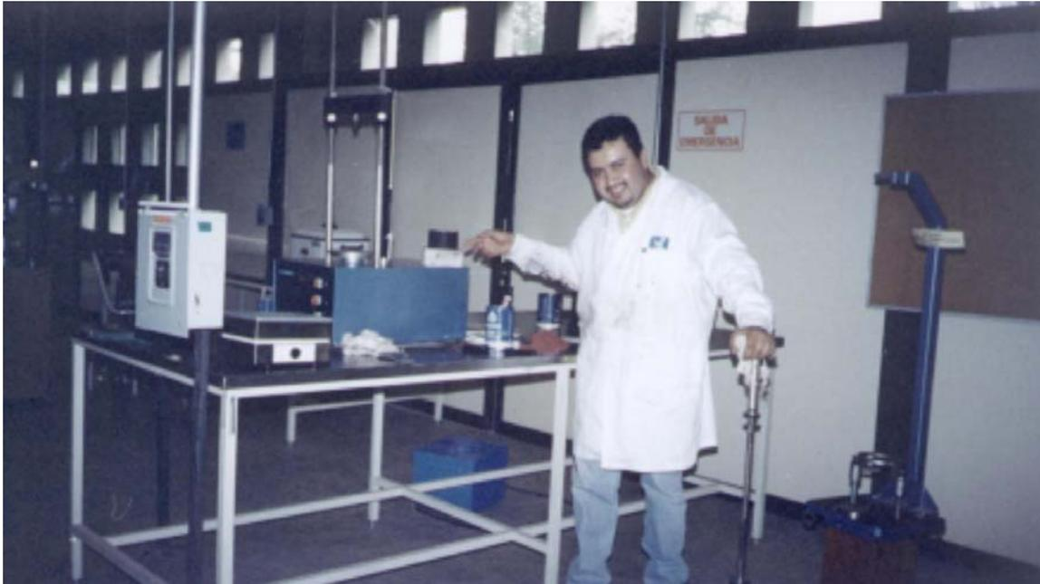
**Figura 4.3- 9 Proceso de elaboración de las probetas por método dinámico empleando el martillo Marshall.**
