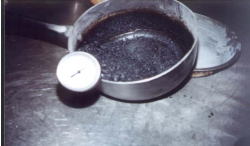
**Figura 4.3- 6 Temperatura de compactación de la Mezcla para Concreto Asfáltico.**
