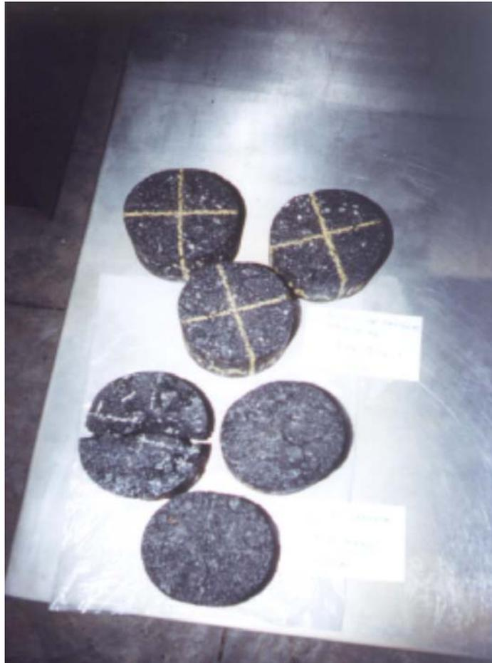
**Figura 5.5-3 Condiciones de las probetas expuestas en ácido acético por período de 14 días.**
