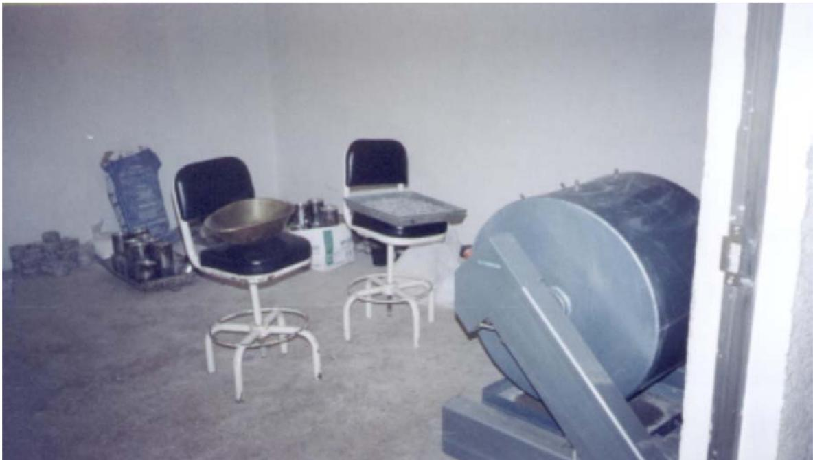
**Figura 4.2- 4 Proceso para determinar el porcentaje de desgaste del material pétreo en máquina de los ángeles.**
