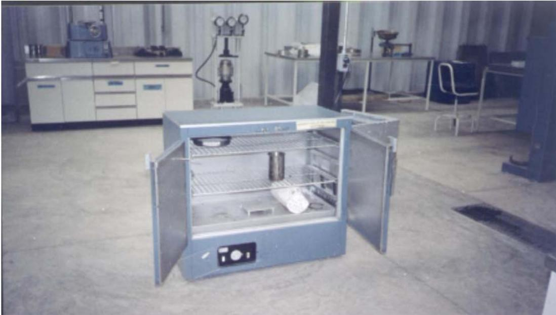
**Figura 4.2-7 Secado al horno del Material Pétreo para determinar su absorción.**
