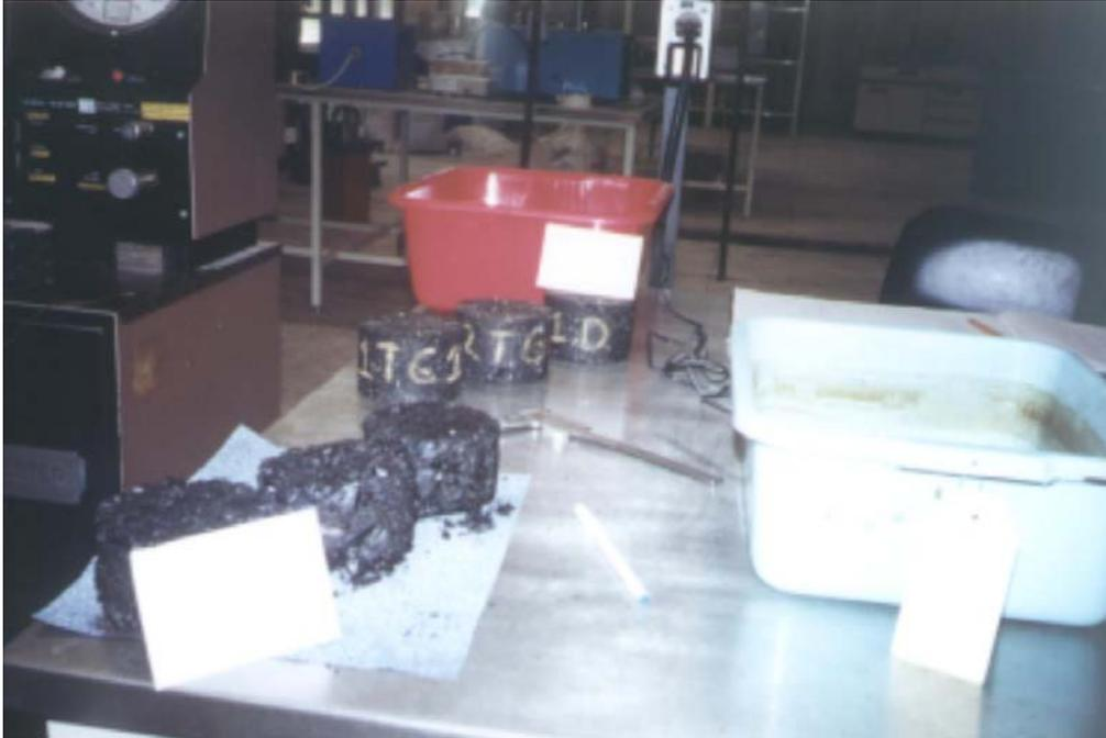
*Figura 5.1-1 Apariencia que mostraron las probetas al concluir el proceso de exposición en gasolina 24 horas.*
