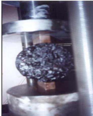
**Figura 4.5-3 Forma en que se colocan las probetas en la Versa Tester para su ensaye a Tensión Indirecta.**
