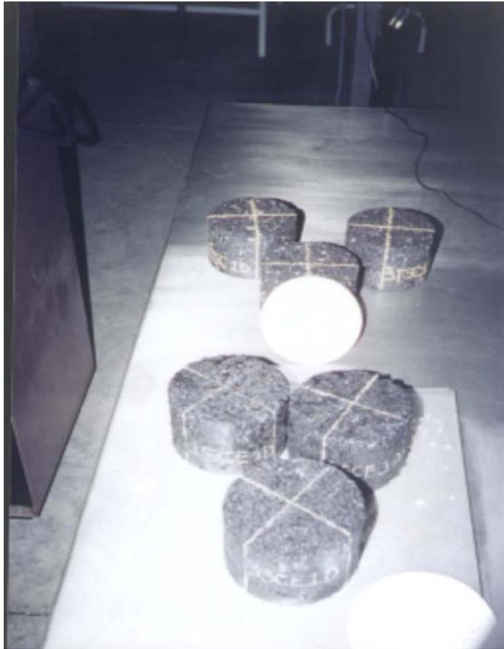
**Figura 5.6-2** Apreciación que se tiene de las probetas expuestas en sosa cáustica por un lapso de 24 horas.
