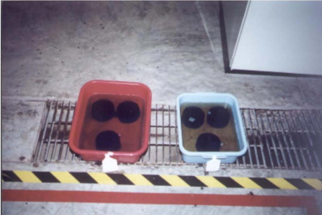
**Figura 4.4-1 Condiciones en que son sometidas las probetas a la exposición de sustancias agresivas.**
