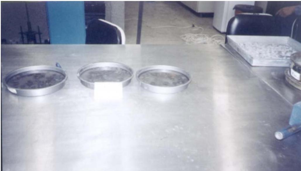
**Figura 4.2- 5 Saturación del material pétreo para determinar su absorción y densidad.**
