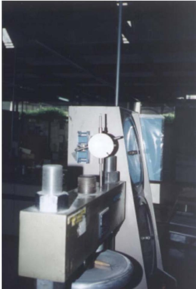
**Figura 4.5-2 Instrumentación de la Versa Tester con micrómetro para medir deformaciones verticales.**
