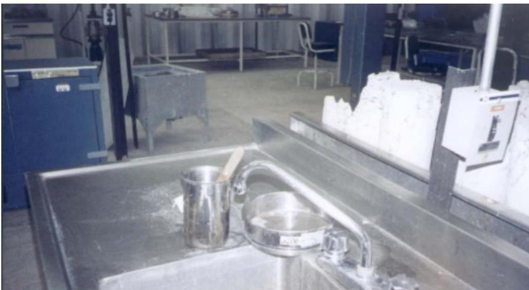
**Figura 4.2- 3 Proceso para determinar la granulometría fina del material que pasa la malla No. 4.**
