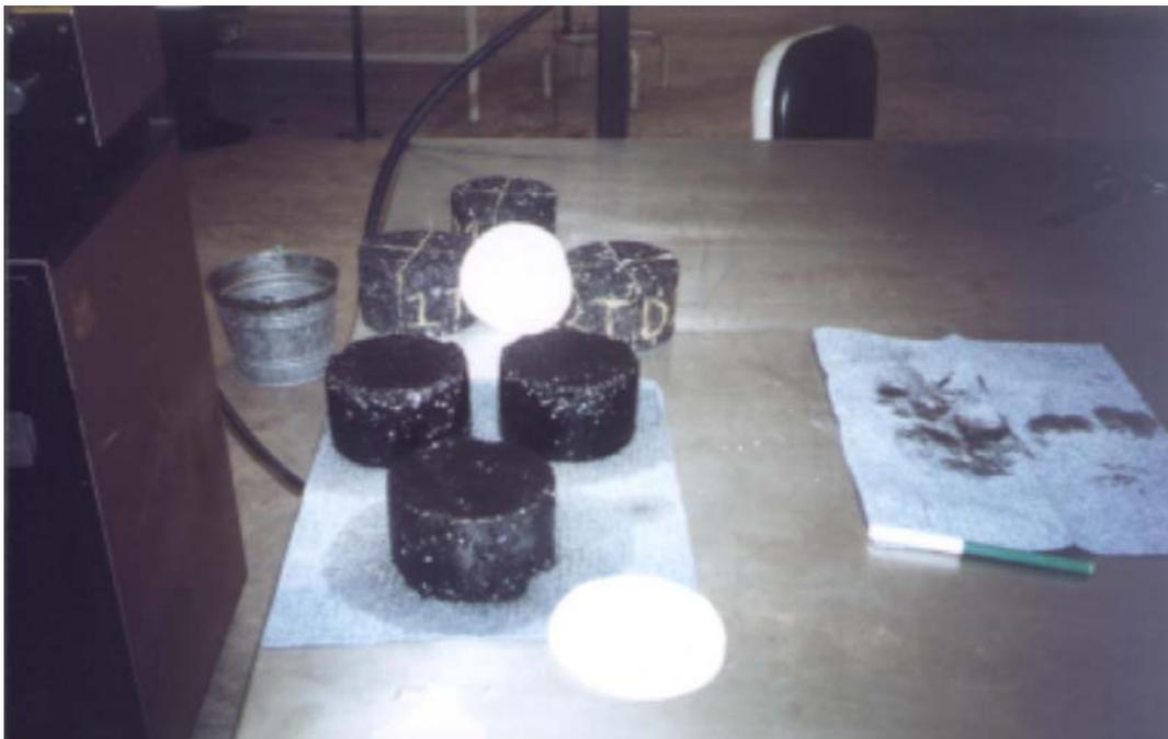
**Figura 5.2-1 Condiciones de las probetas expuestas en diesel 24 horas.**
