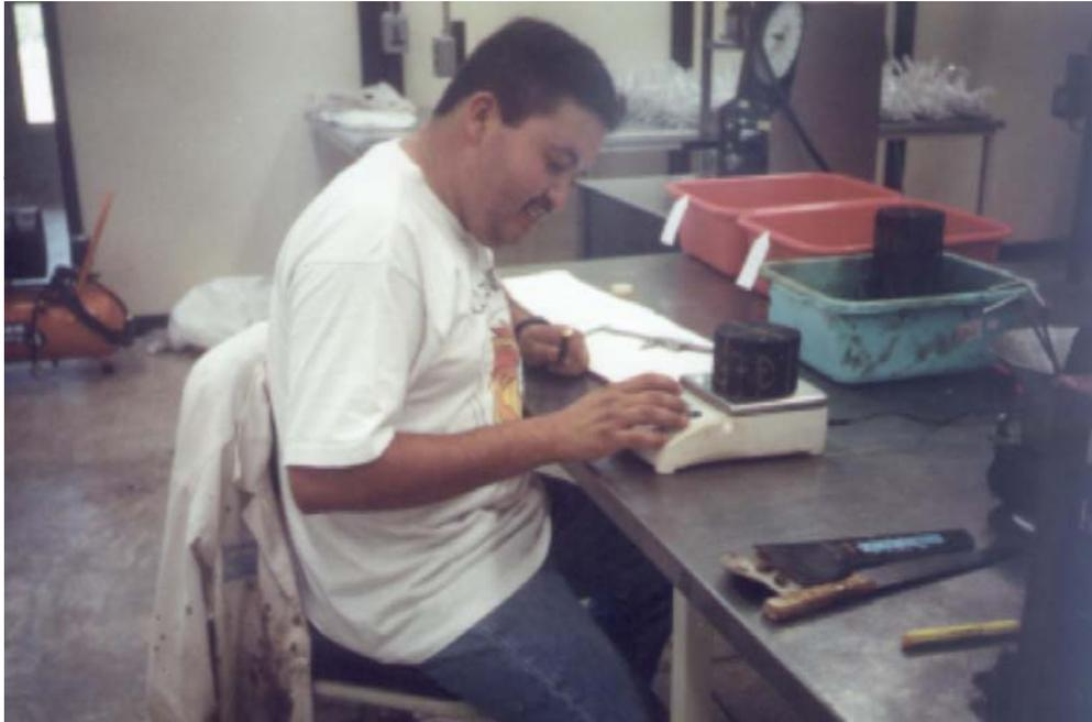
**Figura 4.5-6 Determinación del Peso de las Probetas.**
