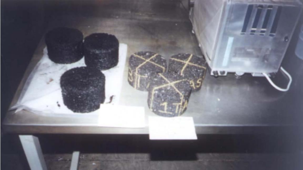
**Figura 5.3-1 Imagen de las probetas expuestas 24 horas en ácido sulfúrico.**
