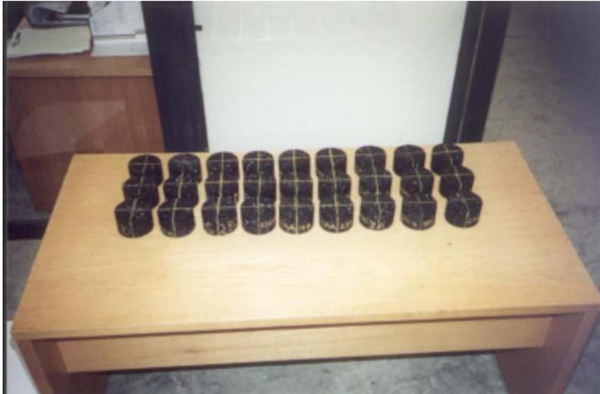
**Figura 4.5-4 Fase final de la elaboración de las probetas por proceso estático.**
