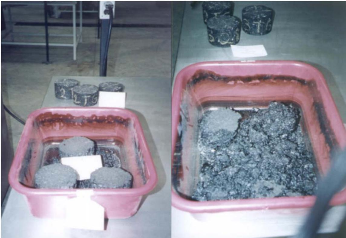
**Figura 5.1- 4 Probetas al concluir el período de exposición 28 días (imagen izquierda), aspecto de las probetas después del ensaye a tensión indirecta (imagen derecha).**
