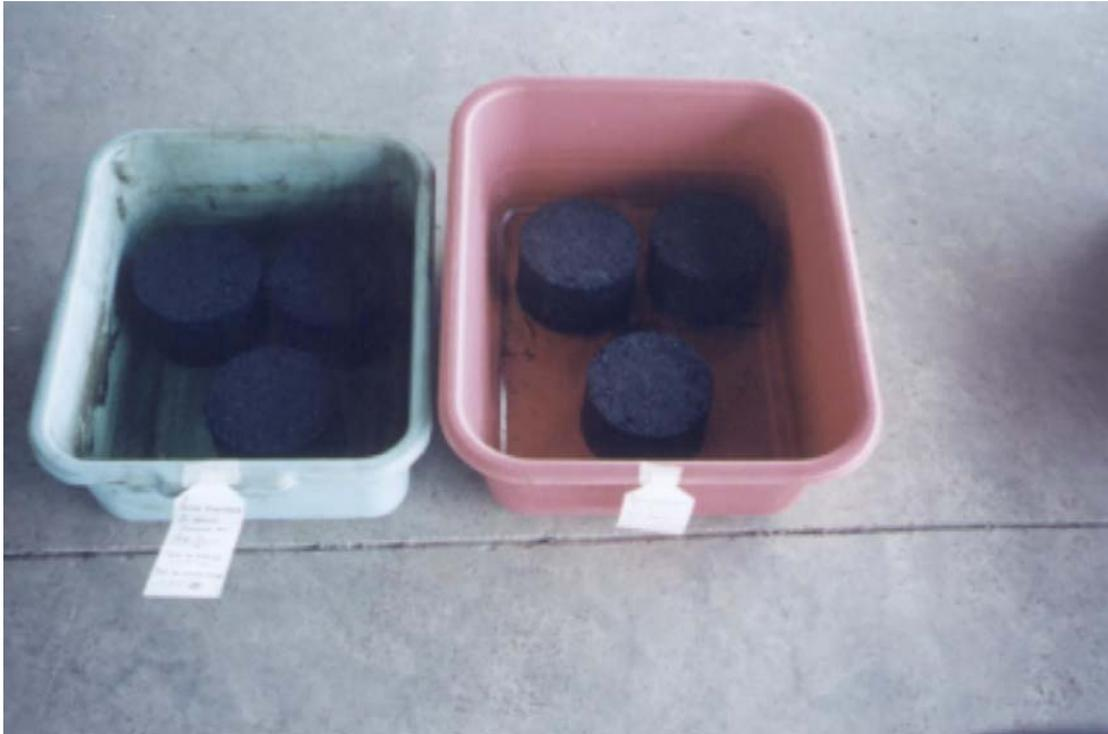
**En esta figura se muestra como en las bandejas que contienen las probetas Figura 5.5-2 expuestas por 14 y 28 días en ácido acético, este a desaparecido completamente del interior de las mismas.**
