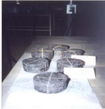
**Figura 5.6-4 Imagen de las probetas expuestas en sosa cáustica al finalizar el proceso de inmersión a 14 días.**
