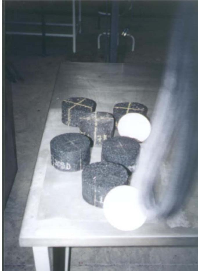
Figura 5.5-1 Aspecto de las probetas expuestas por 7 días en ácido acético.
