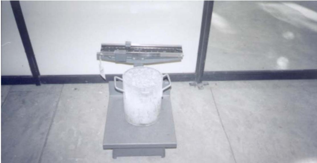
**Figura 4.2-1 Proceso para determinar el peso volumétrico seco suelto.**
