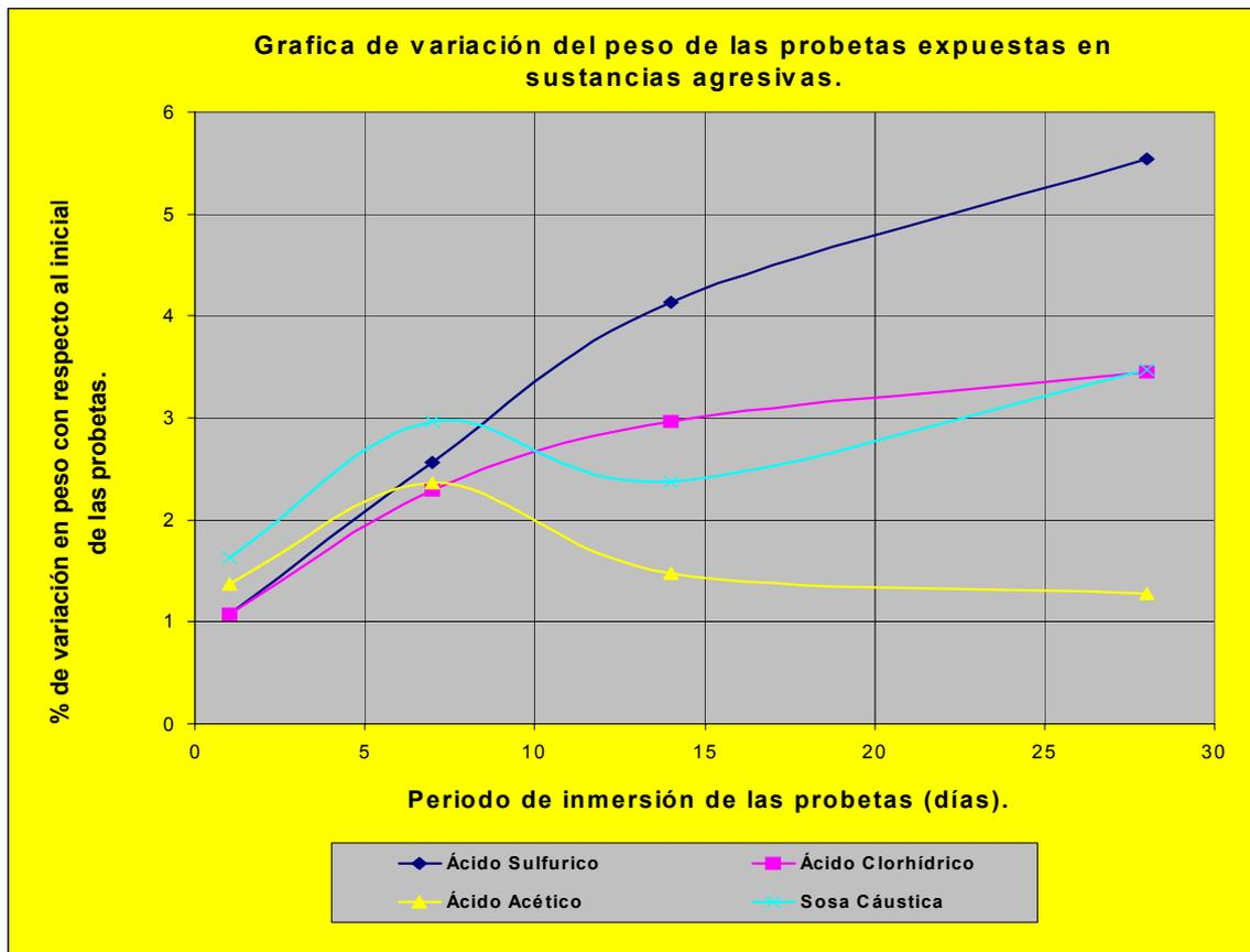
**Gráfica 5.8-A Gráfica de variación del peso inicial de las probetas expuestas en las sustancias agresivas analizadas (Al finalizar los tiempos de exposición).**
