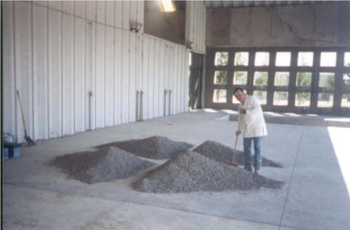
**Figura 4.1- 3 Cuarteo del material pétreo para la elaboración de probetas de Concreto Asfáltico.**
