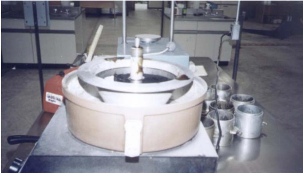
Figura 4.3- 2 Proceso para determinar el contenido de cemento asfáltico con máquina rotarex.
