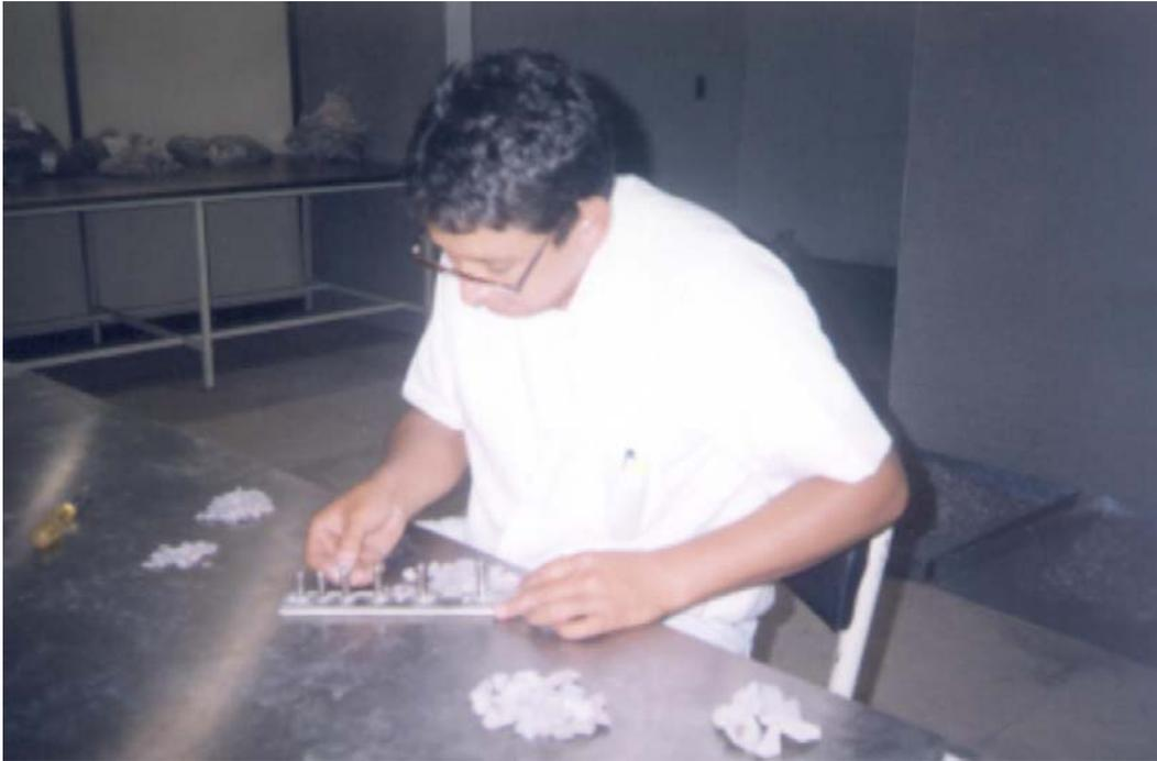
**Figura 4.2- 9 Proceso para determinar el porcentaje de partículas alargadas.**
