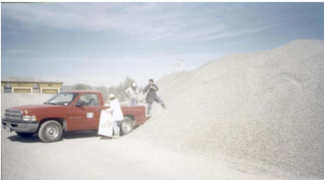
**Figura 4.1-2 Muestreo del material pétreo para la elaboración de probetas de concreto asfáltico.**
