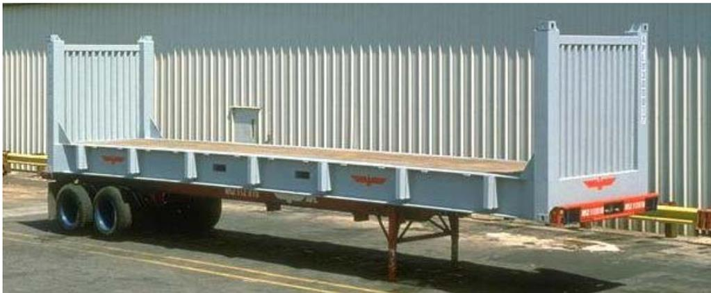
**Contenedor tipo bastidor (Flat Rack) para cargas pesadas**
