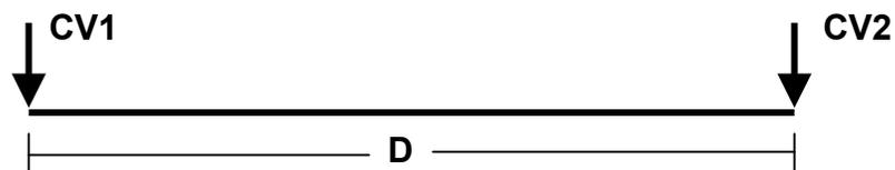
En esta figura los símbolos CV1 y CV2 representan a las “**cargas virtuales**” del “**vehículo virtual**”, y D es la distancia entre ellas; el cálculo de los valores que deben asumir estos componentes, de manera que se logren niveles de seguridad estructural adecuados a las condiciones reales del tránsito vehicular en México, es la parte fundamental de este trabajo. Las dimensiones de las áreas de contacto (vista en planta) de las cargas virtuales, se determinan en función de sus magnitudes.
