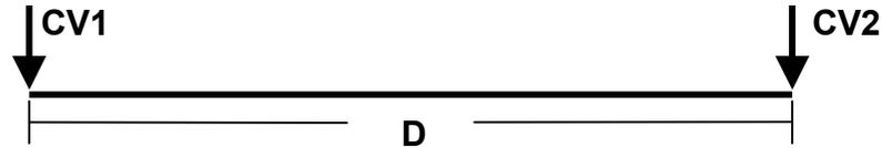
La carga virtual CV1 representa al peso que transmite el eje delantero, en tanto que CV2 corresponde al peso del tándem.
