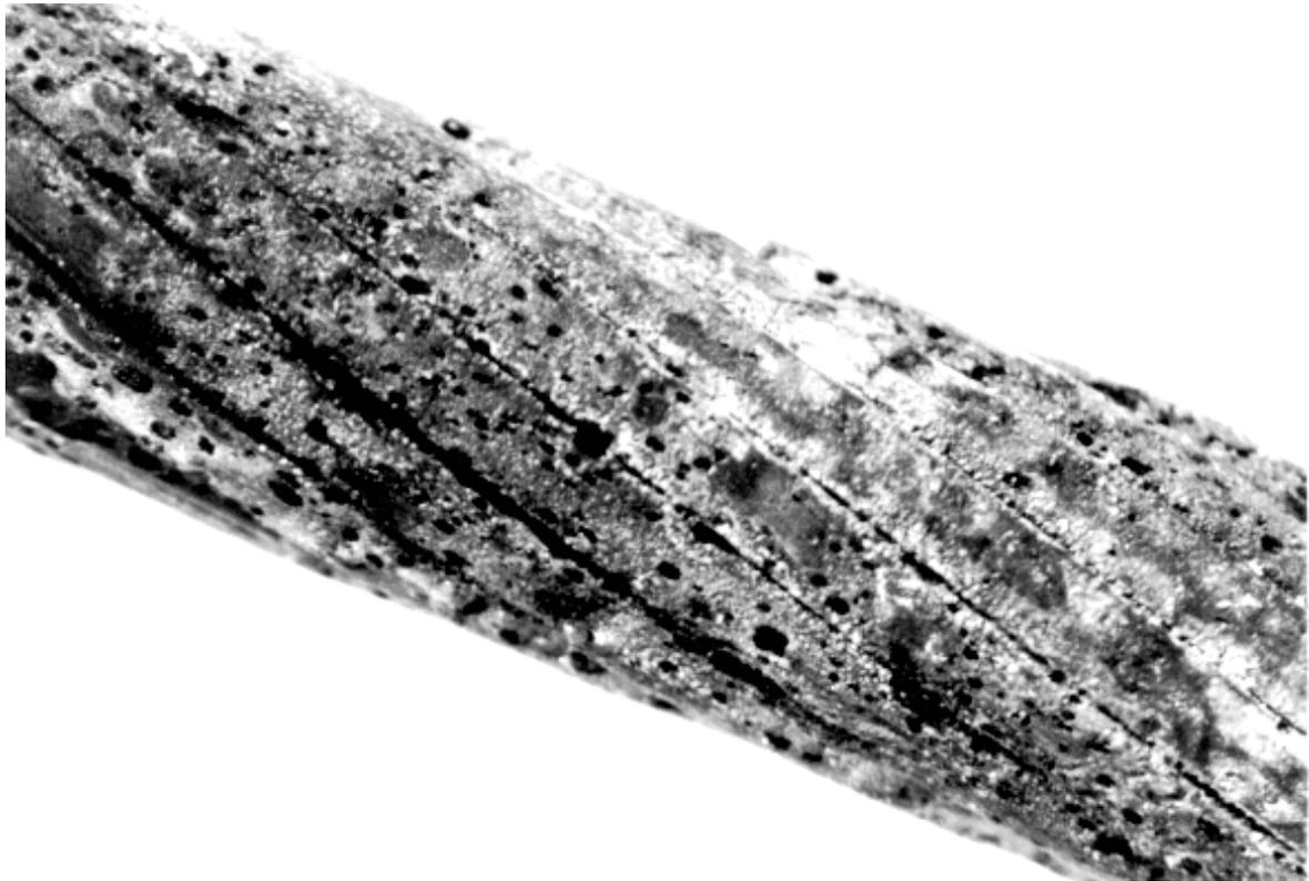
**Figura 18. Fotografía del cable corroído con solución de  $H_2SO_4$  al 1% en volumen.**
