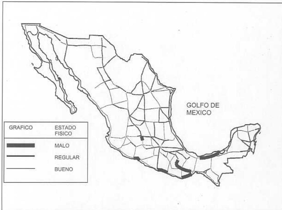
Figura 5.1. Estimación del estado superficial de la red carretera pavimentada.
