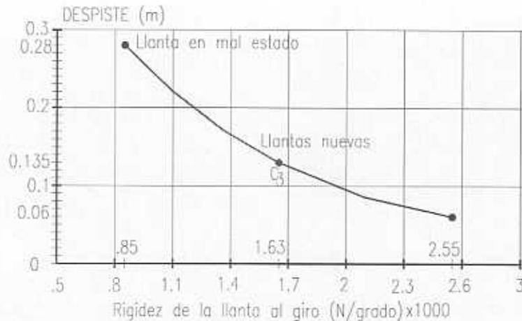
Figura 20. Influencia de la rigidez de la llanta al giro, en un camión C3 circulando en una curva de 360 m de radio a 90 km/h.
