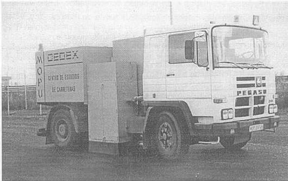
Figura 14. Equipo para la medida del coeficiente al deslizamiento.
