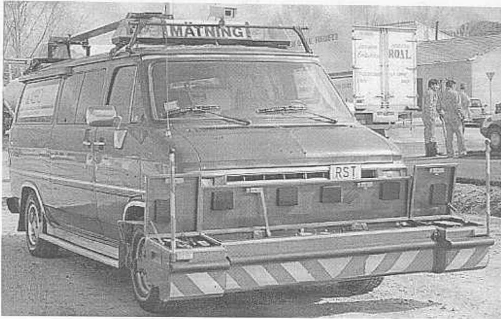
Figura 21. Equipo RST (Road Surface Tester) sueco.
