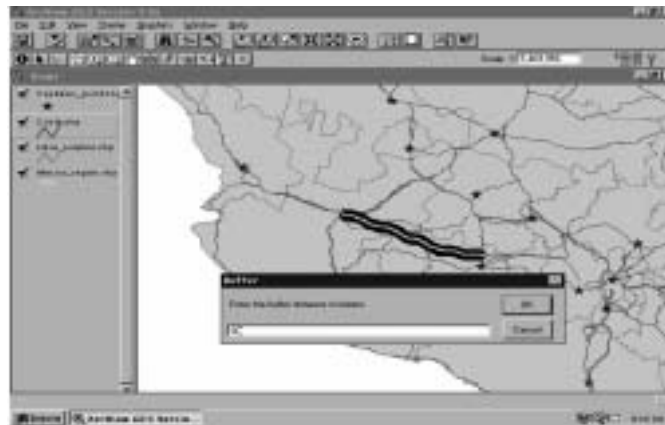
Figura 1.15 Proximidad. Creación de un buffer de 60 metros equivalente al derecho de vía
