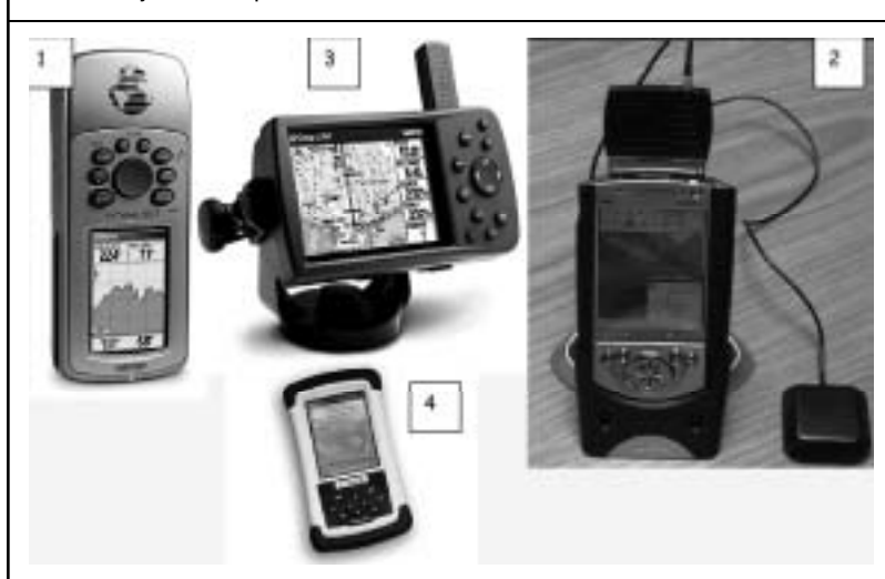
Figura 1.30 Receptores GPS: 1. Garmin GPSMAP76 CS, 2. Garmin 12 XL con tarjeta de adaptación a PC Pocket, 3. GPSMAP 276C, 4. Trimble Recon
