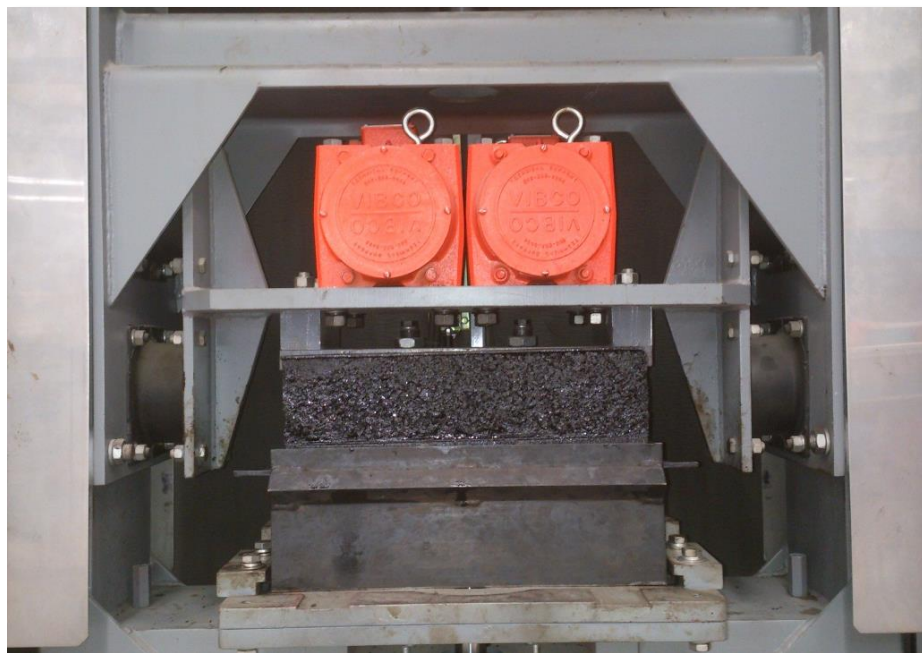
Figura 20. Compactación de vigas para ensayo de fatiga
