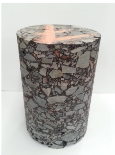
Figura 19. Especimen de mezcla asfáltica para ensaye de modulo complejo
