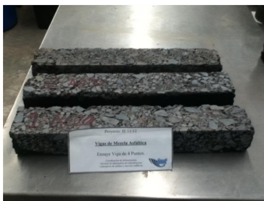
Figura 21. Vigas preparadas para ensayo de fatiga
