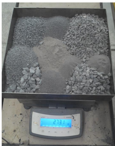
Figura 17. Dosificación del agregado para la fabricación de las mezclas asfálticas
