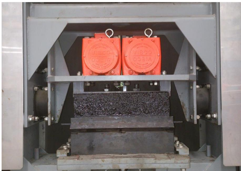
Figura 5-6 - Compactación de vigas para ensayo de fatiga
