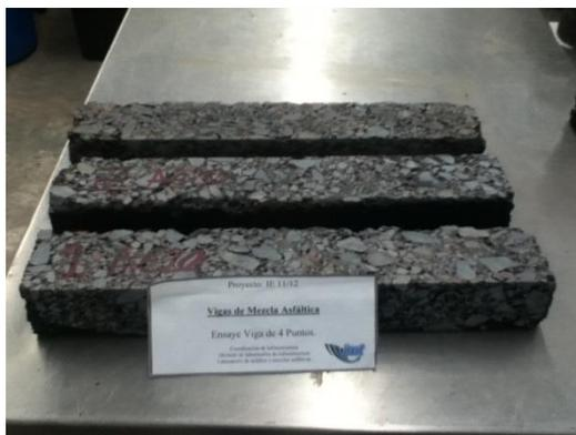
Figura 5-7 - Vigas preparadas para ensayo de fatiga
