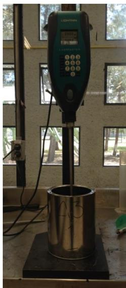
**Figura 5-3 - Incorporación de aditivo al asfalto.**
