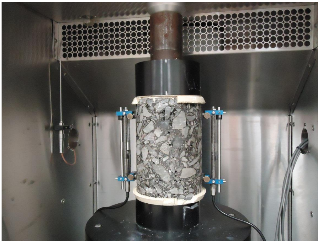
Figura 7 Instrumentación del espécimen de ensayo de Módulo dinámico
