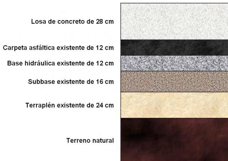
Figura 4. Sección estructural típica del libramiento Noreste de Querétaro.
