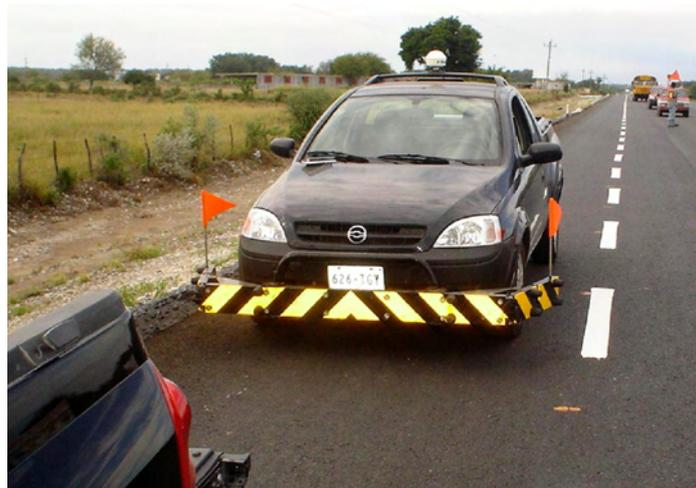
Figura 45 Perfilómetro Láser utilizado para la evaluación superficial del Libramiento Noreste de Querétaro del km 0+000 al 37+000.
