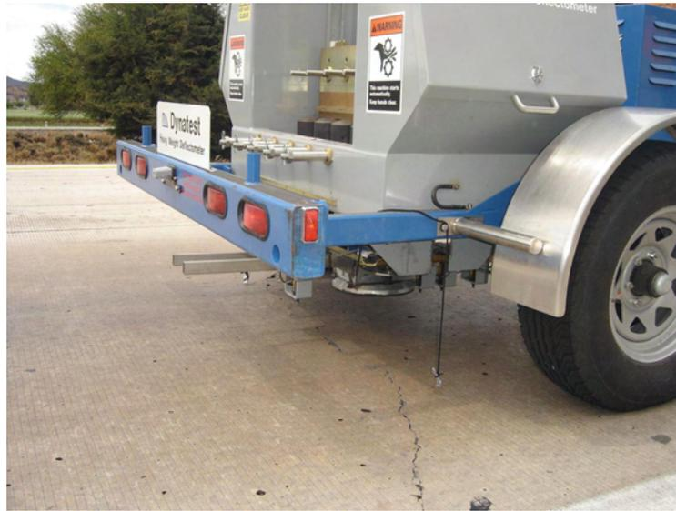
Figura 6 Deflectómetro de impacto utilizado en la evaluación estructural del libramiento Noreste de Querétaro.
