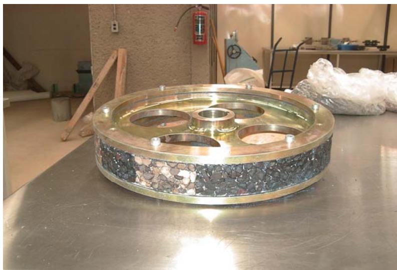
Fig. 3 Especímenes montados alrededor de la periferia de la rueda metálica
