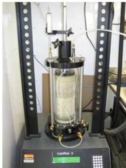
Figura 5.3 Equipo triaxial cíclico para obtener módulos resilientes en materiales granulares.
