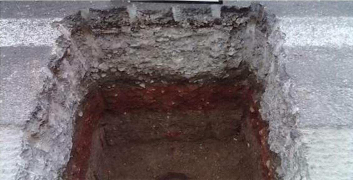
**Figura 3.4 Detalle de espesores de pavimento de un pozo a cielo abierto.**
