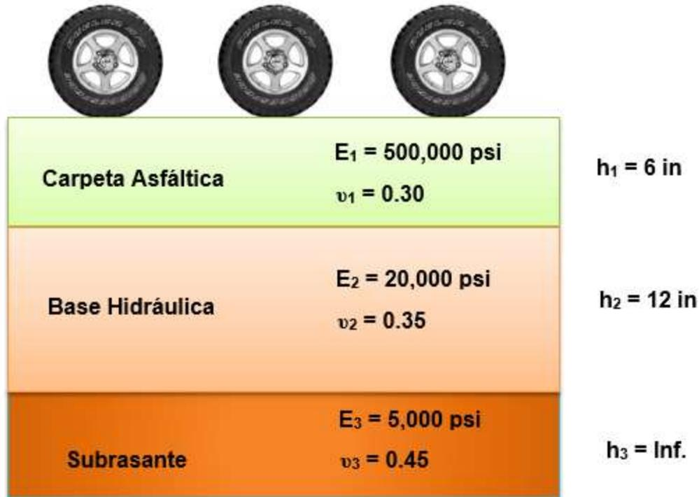
**Figura 17.27 Estructura tricapa para análisis de sensibilidad 2.**
