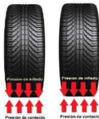
**Figura 2.1 Presión de contacto y presión de inflado de los neumáticos.**
