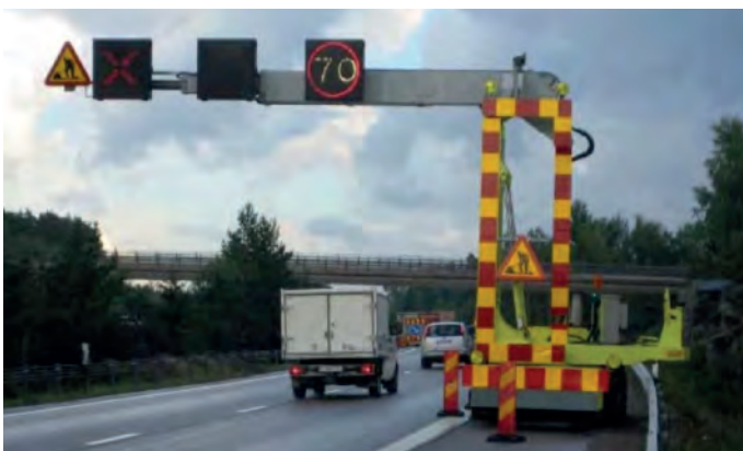
Figura 1. Grúa para despliegue de señalización de obra.
