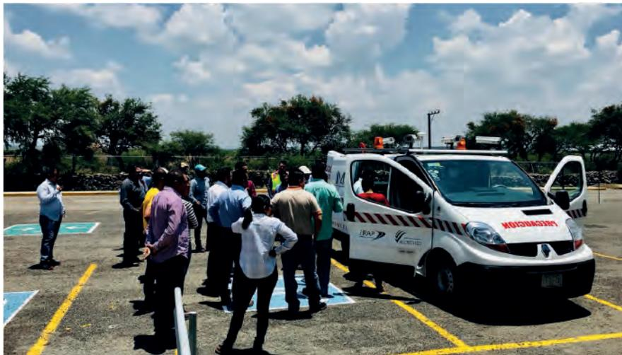
Participantes conociendo el equipo Hawkeye 2000 del IMT que sirve para realizar levantamientos fotográficos georreferenciados y obtener datos sobre la geometría de una vía.
