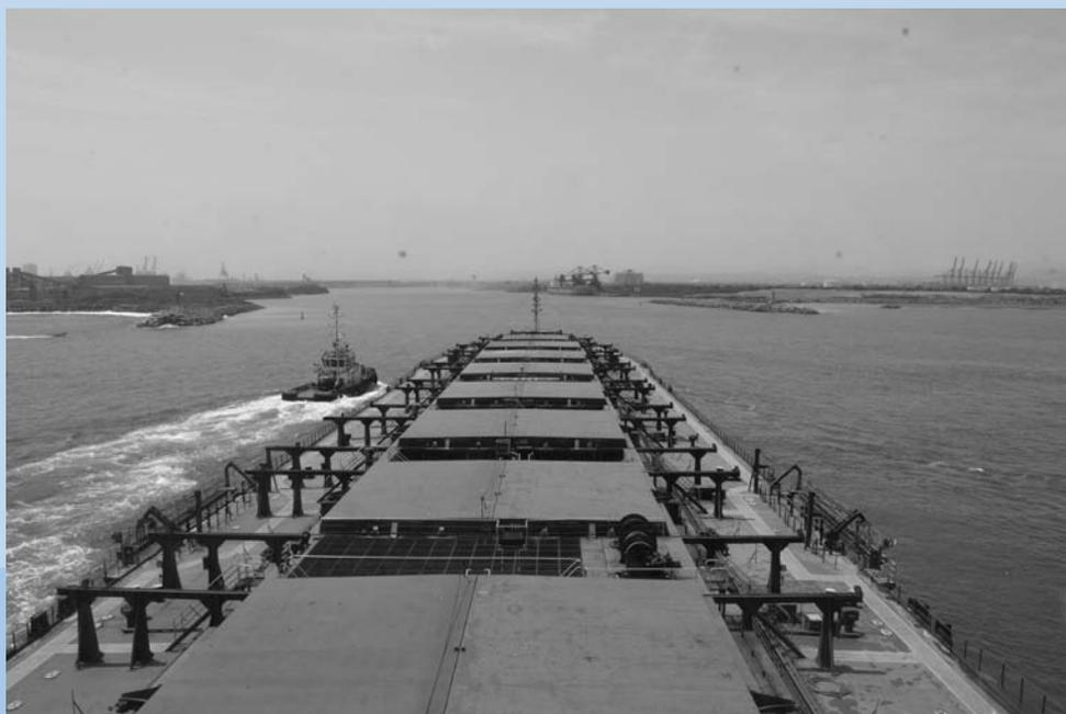
**Embarcación de tipo Granelero (Bulk Carrier), dimensiones Eslora: 247 m , Manga: 42 m, Calado: 13.4 m, vista desde el puente de la embarcación, a babor se ve un remolcador acompañando para asistir**
