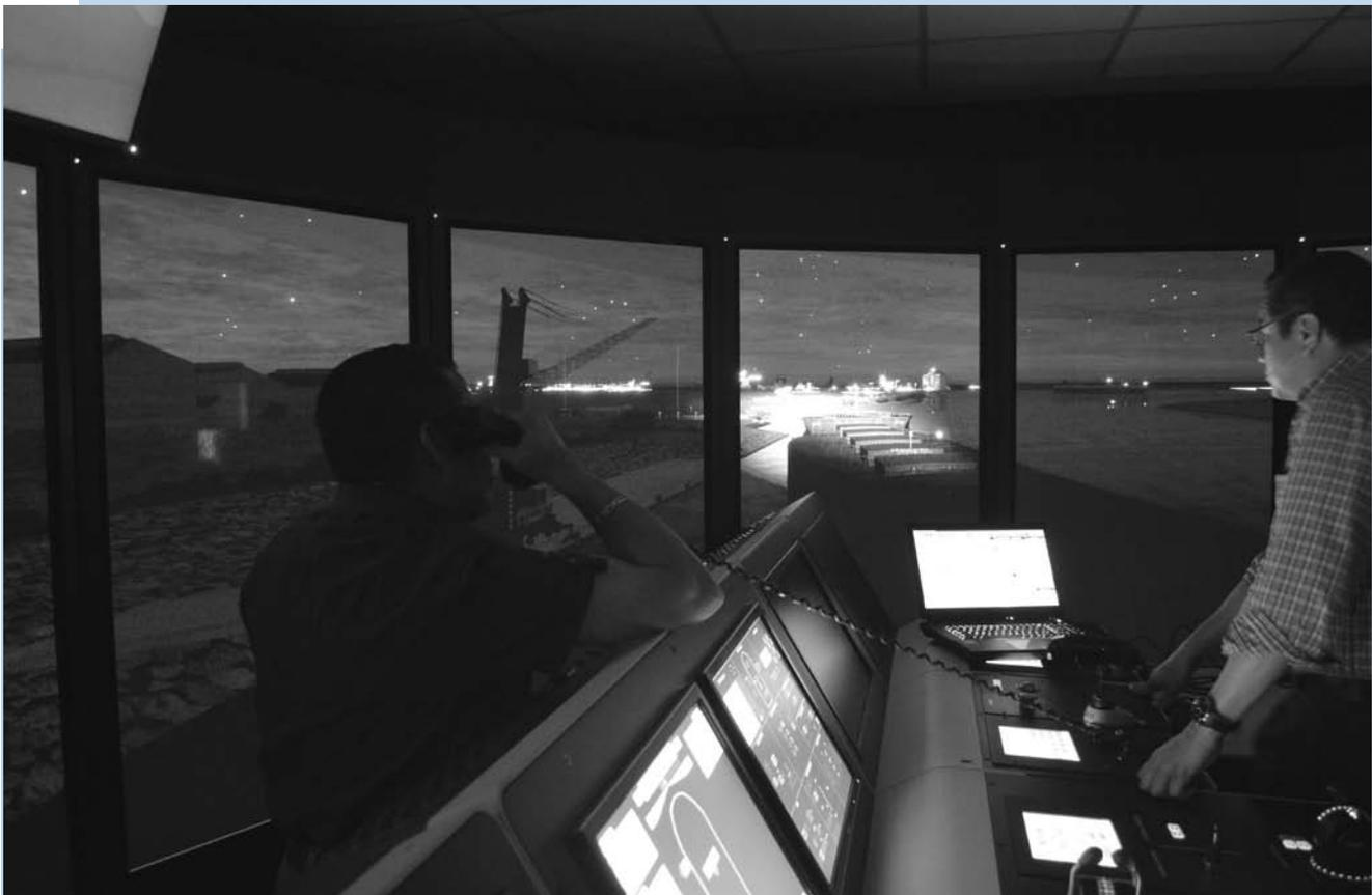
**Embarcación de tipo Granelero, vista desde el puente del Simulador, realizando maniobra de atraque con un escenario Nocturno**
