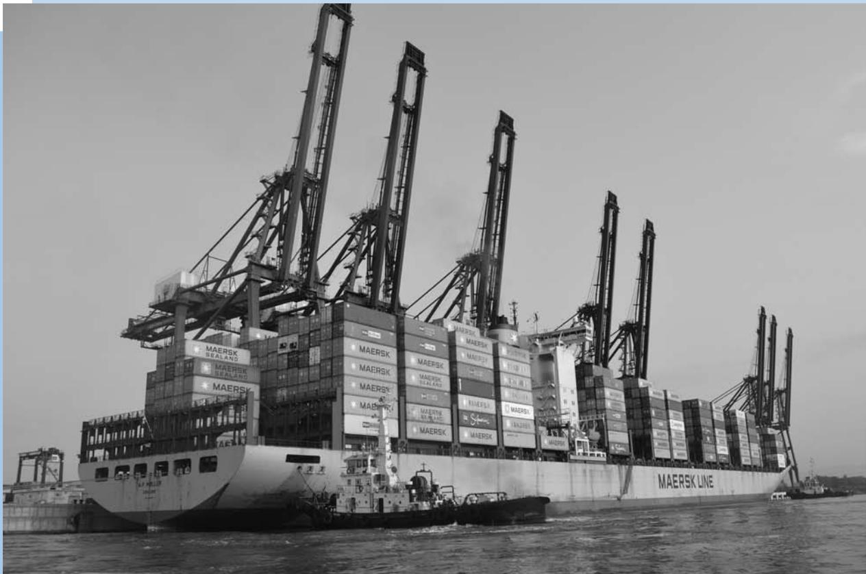
**Embarcación superpost panamax, Porta contenedor, dimensiones Eslora: 347 m, Manga: 42 m, Calado: 13.45 m; del lado estribor, se encuentran dos remolcadores**
