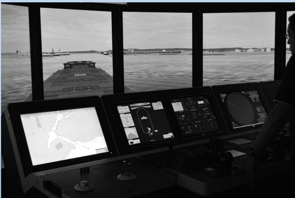
**Embarcación de tipo Granelero (Bulk Carrier), vista desde el puente del Simulador, se observan las consolas que proporcionan información al Piloto**
