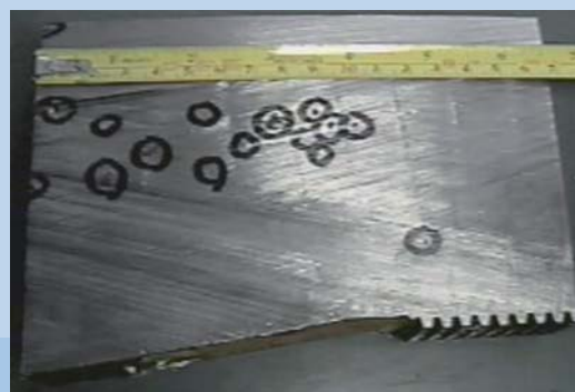
Figura 3 Inclusiones y porosidades del elemento de anclaje analizado en 2000
