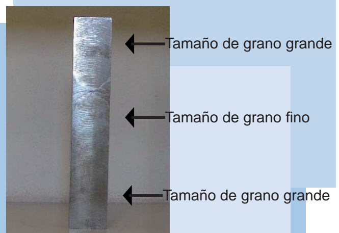
Figura 5 Probeta para determinar el tipo de señales de ultrasonido
