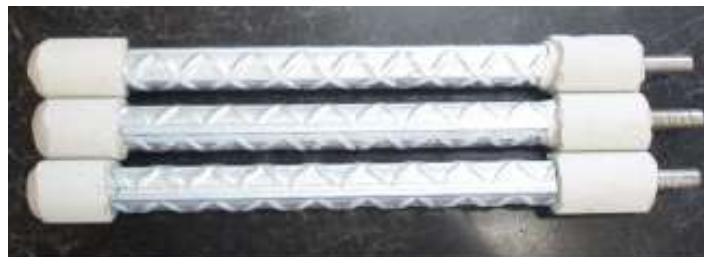
Figura 2.3 Varillas galvanizadas con aislamiento en los bordes
