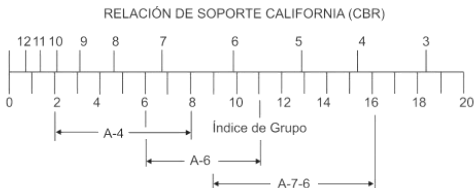
Figura 1.7 Relación entre el CBR, Índice de grupo y clasificación AASHTO (adaptada de ODOT 2008)
