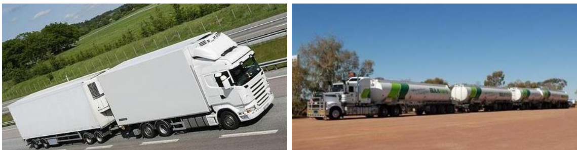
Figura 1.2 Configuraciones vehiculares de más de una unidad
