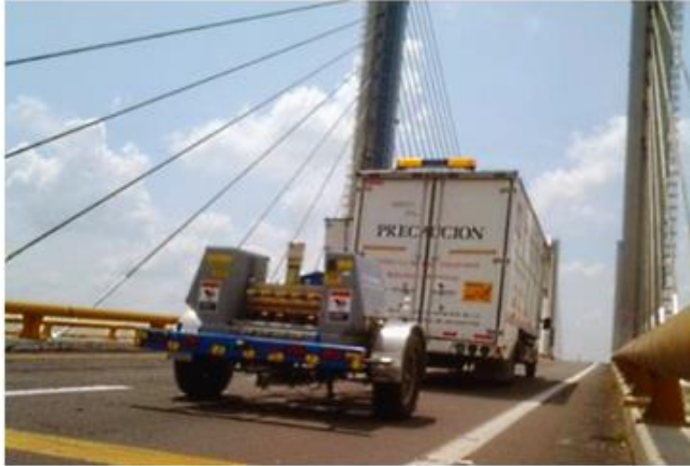
Figura 2.2 Deflectómetro de impacto en las pruebas de carga del puente Río Papaloapan.
