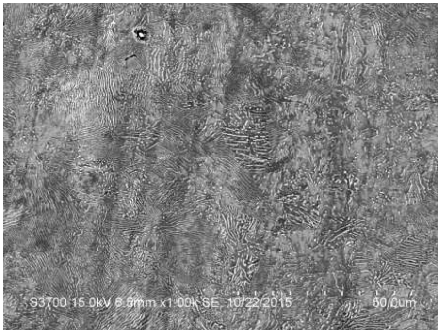
Figura 4.2 Microestructura de ferrita y perlita del acero 4140 observada en el microscopio electrónico de barrido.
