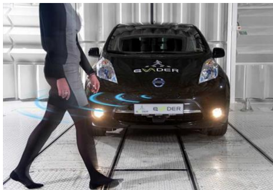
Figura 4.22 Visualización del eVADER, señales auditivas para que los peatones perciban la presencia de un vehículo eléctrico
