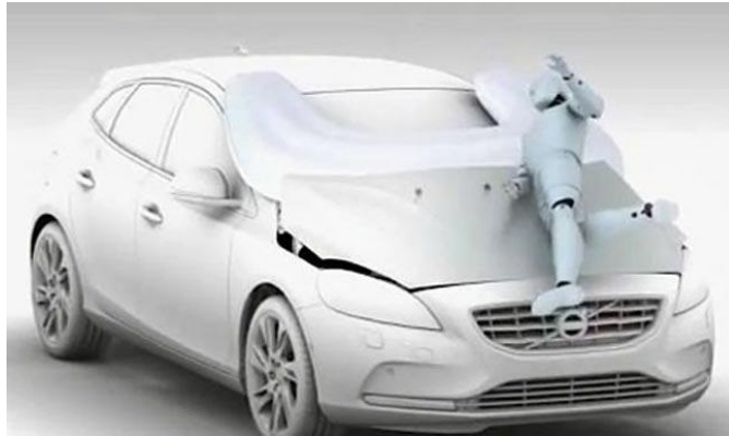
Figura 4.20 Dispositivo vehicular Pedestrian Airbag Technology accionado para amortiguar los atropellamientos frontales
