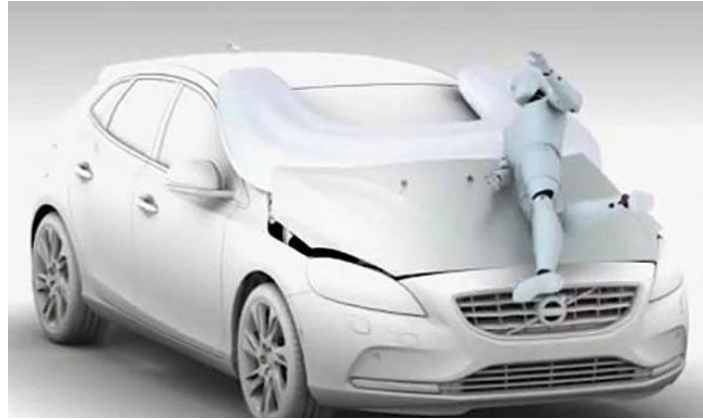
Figura I.13 Dispositivo vehicular Pedestrian Airbag Technology accionado para amortiguar los atropellamientos frontales
