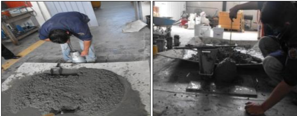
Figura 3.5. Prueba del revenimiento para verificar la calidad de la mezcla y fluidez, revenimiento de proyecto 10 cm, tolerancia \pm 3.5 cm
