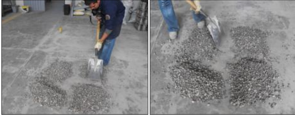
Figura 1.1. Procedimiento por cuarteo con pala
