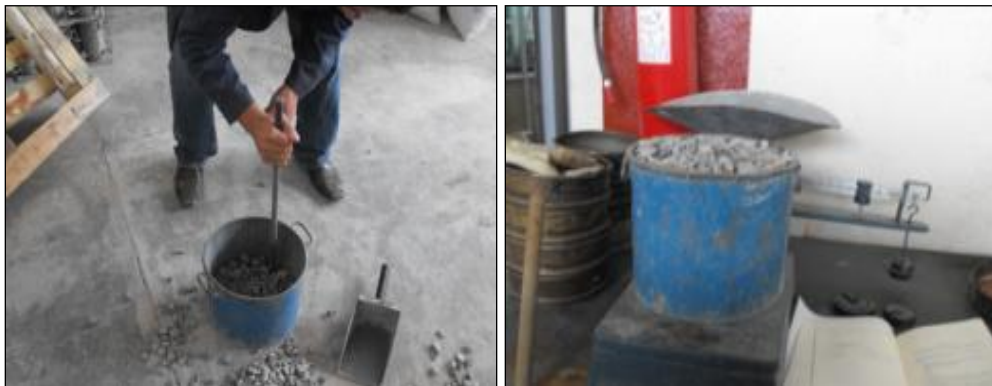
Figura 1.4. Compactación y secado de la muestra.
