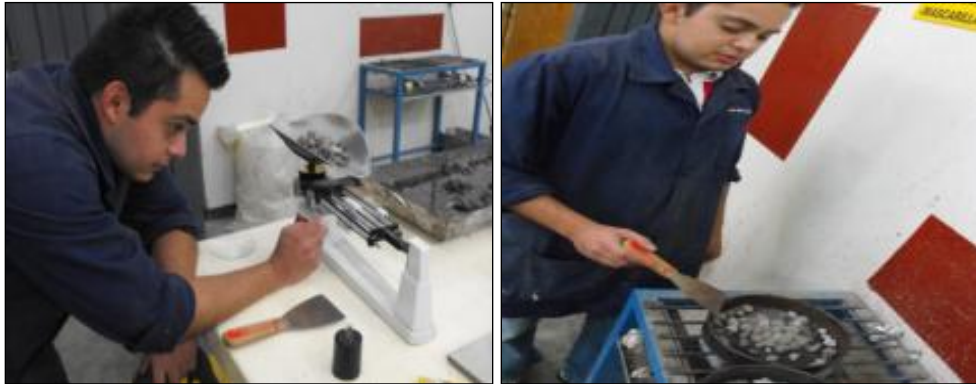
Figura 1.2. Pesado y secado de la muestra
