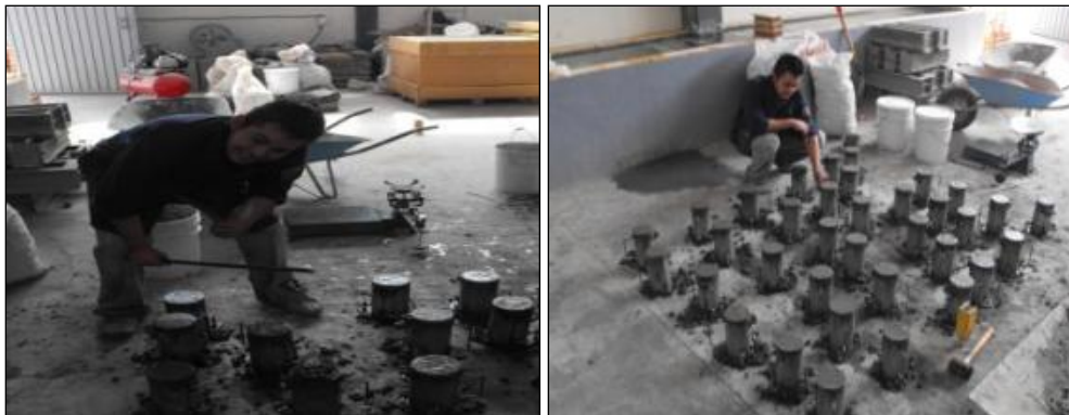
Figura 3.6. Llenado en 3 capas dándose 25 golpes a cada capa con la varilla punta de bala y 15 con el martillo de goma. Descimbrado después de 24 de colado
