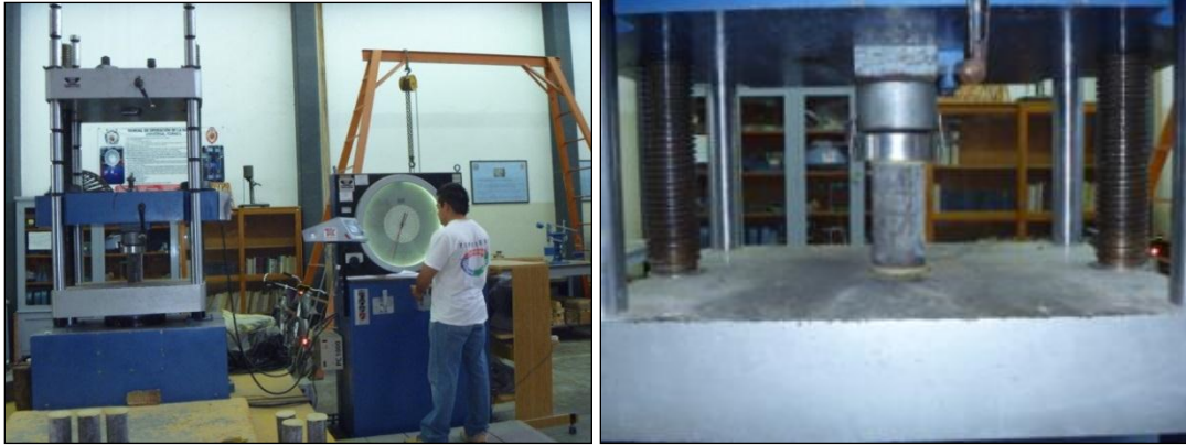
Figura 3.8. Prueba realizada a la muestra controlando la velocidad de carga y registrando su resultado
