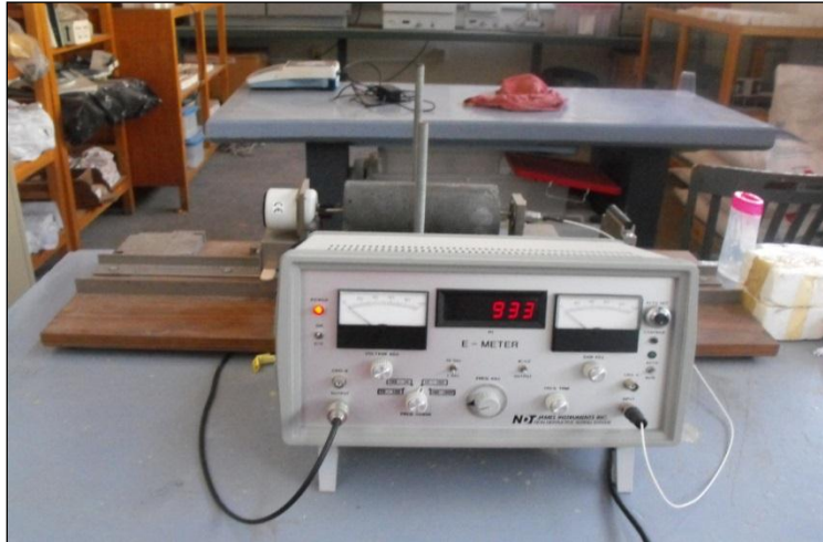
Figura 3.13 Equipo de medición de Frecuencia de resonancia
