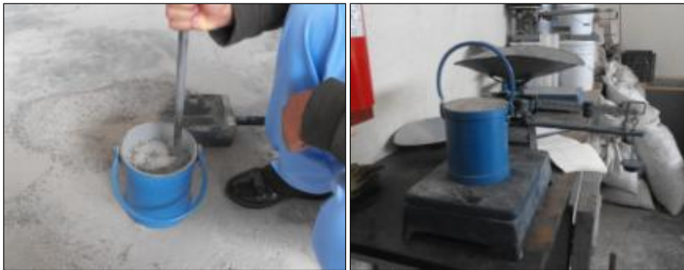
Figura 2.2. Varillado y pesado de la muestra
