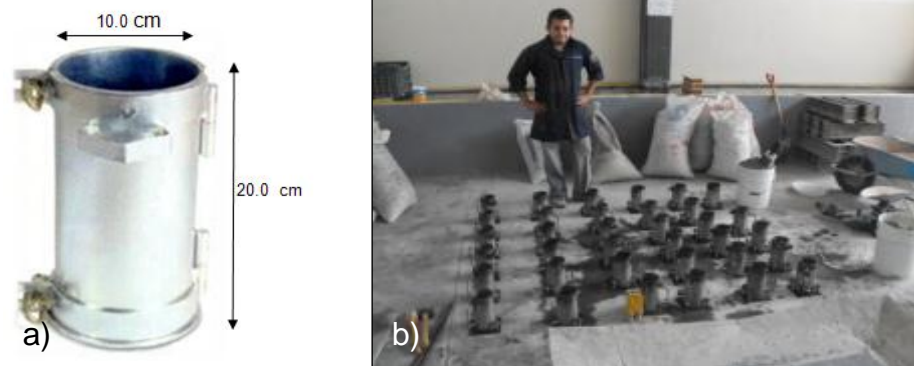
Figura 3.3. a) Dimensiones de los moldes; b) preparación de los moldes y herramienta.
