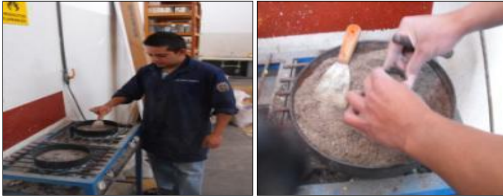
Figura 2.1. Secado de la muestra de forma superficial, con ayuda del cono troncocónico
