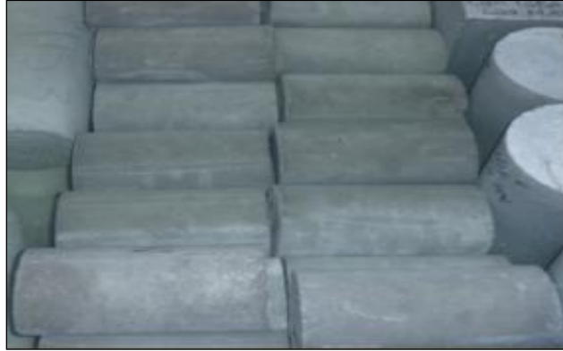
Figura 3.7. Curado en una pila hasta la fecha de su respectiva prueba
