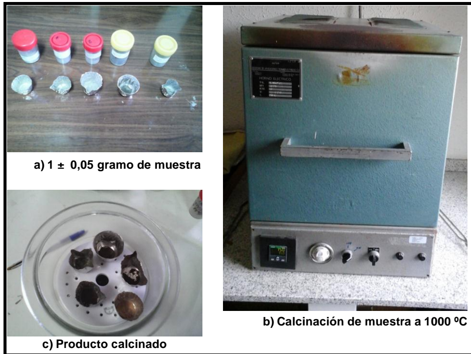
Figura 9. Descripción general de la determinación de la pérdida por calcinación
