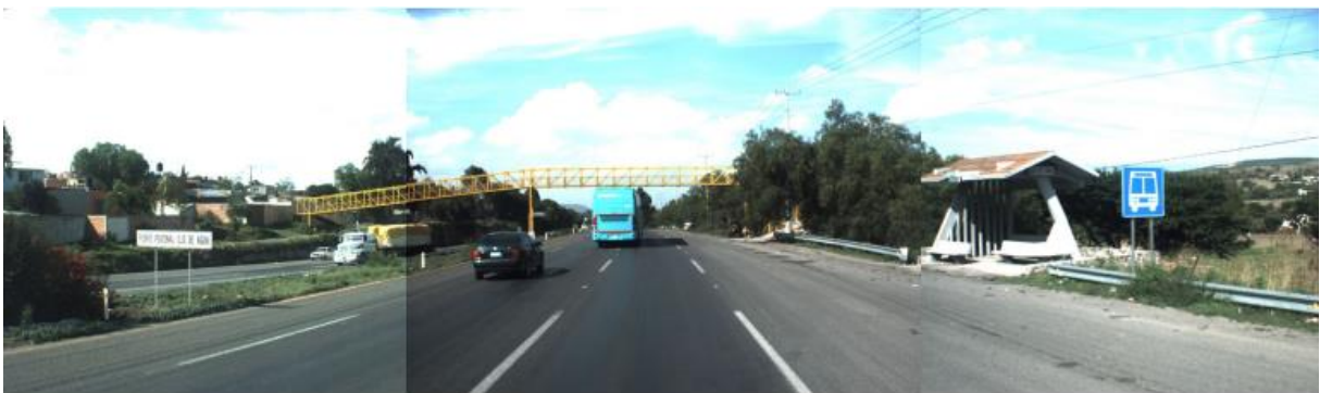
Figura 4.23 Las zonas urbanas y paradas de autobús son ubicaciones incorrectas para la colocación de bandas alertadoras
