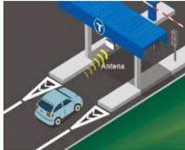
**Figura 2.1 Instalación típica de un carril con cobro electrónico y barrera**
