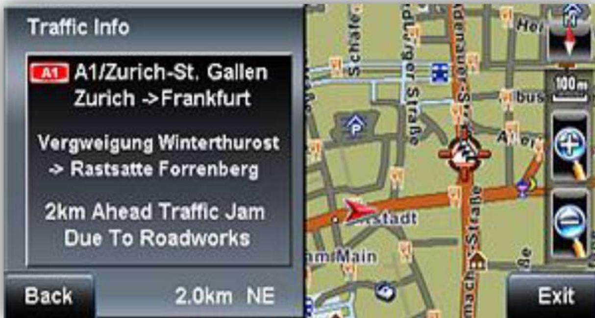
**Figura 3.23 Sistema de navegación por satélite con RDS-TMC**
