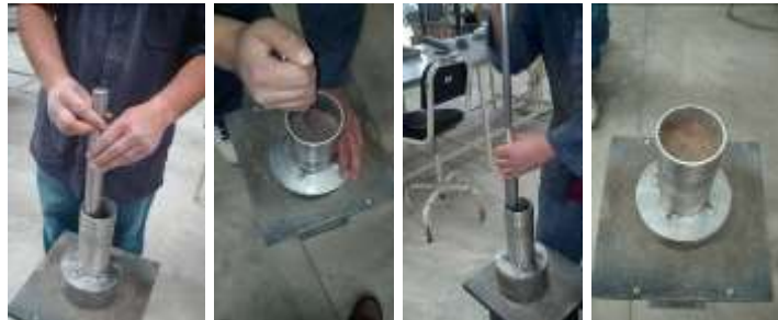
Figura 2.19. Proceso de compactación.
