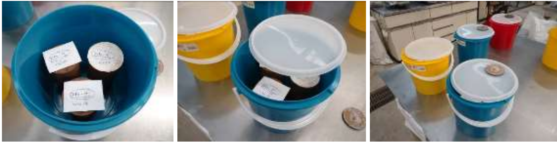
Figura 2.23. Acondicionamiento de especímenes (trayectoria de secado).
