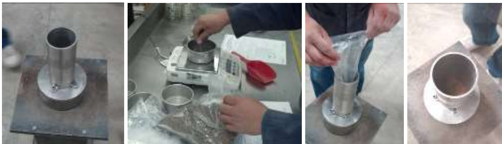
Figura 2.18. Pesaje y colocación del suelo en el molde de compactación.
