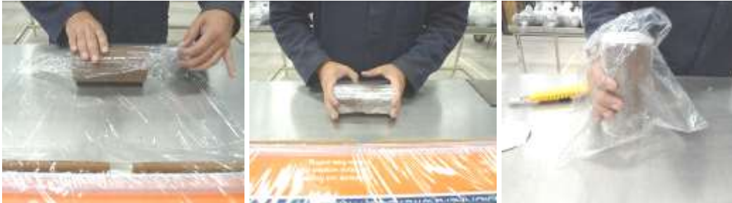
Figura 2.22. Empaque de especímenes compactados.
