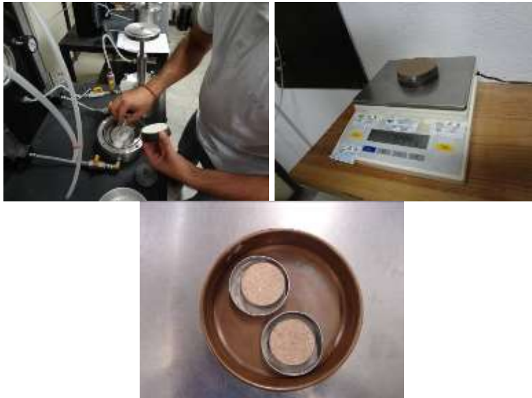
Figura 2.42. Desensamble de la celda de presión y determinación del contenido de agua final.
