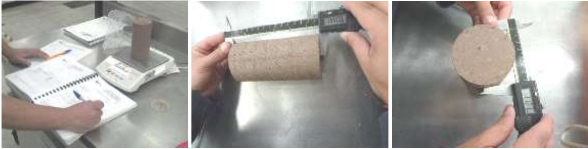
Figura 2.21. Pesaje y medición del espécimen compactado.
