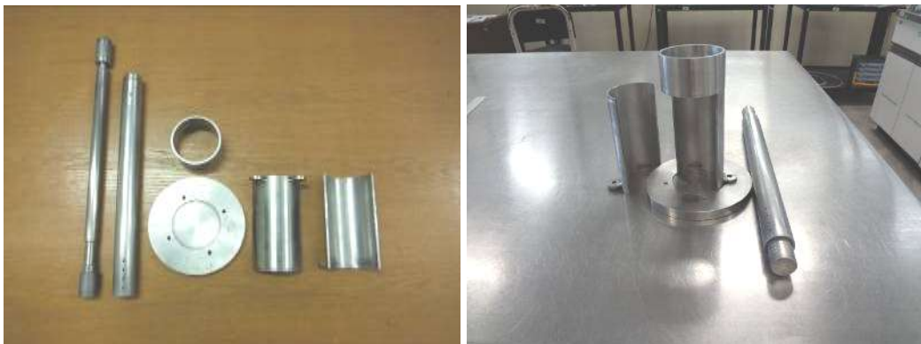
Figura 2.16. Equipo de compactación para la fabricación de los especímenes de prueba.
