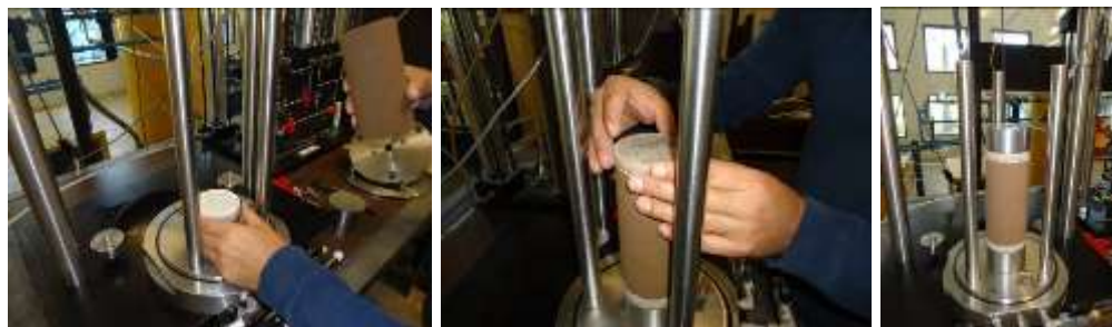
Figura 2.26. Colocación de piedras porosas y papel filtro.
