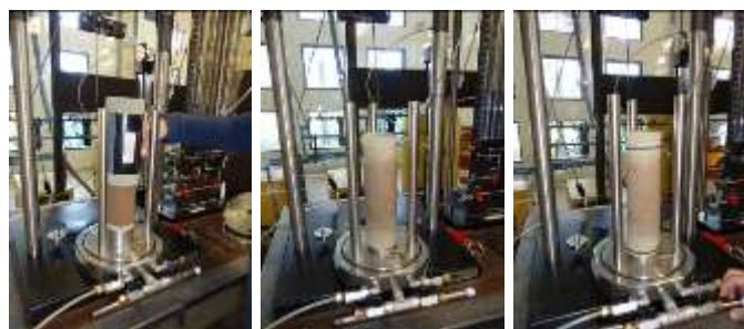
Figura 2.27. Colocación de membrana de látex y o' rings.
