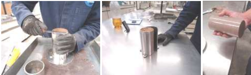
Figura 2.20. Enrase y extracción del espécimen de prueba.
