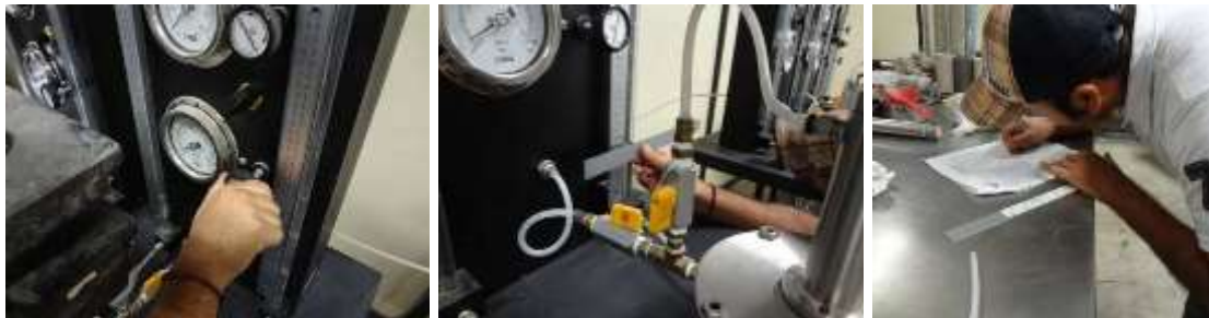
Figura 2.41. Incremento de presiones y toma de lecturas durante la ejecución de la prueba.
