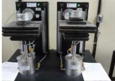
Figura 2.8. Dispositivos de Fredlund para la determinación de la curva característica.
