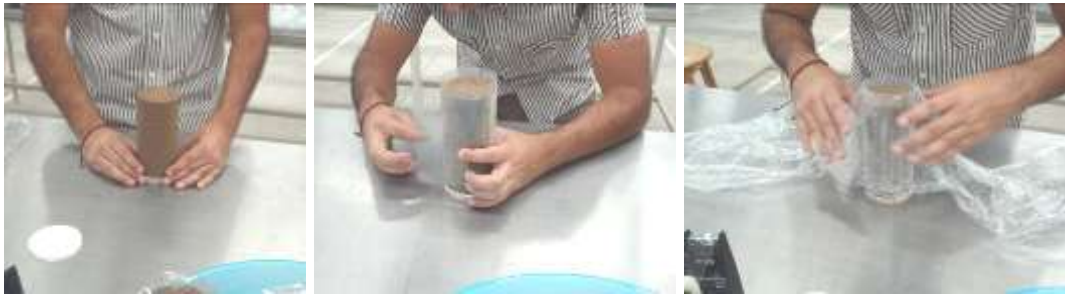
Figura 2.24. Preparación de especímenes para el proceso de humedecimiento.
