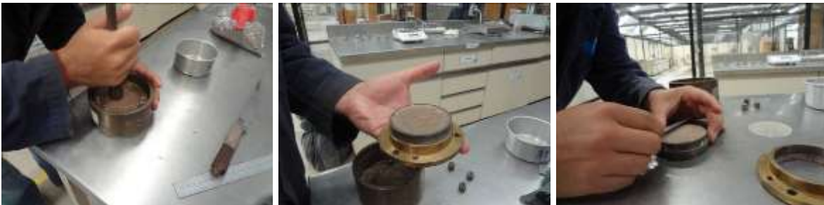
Figura 2.37. Preparación del espécimen de prueba para la determinación de la curva característica.
