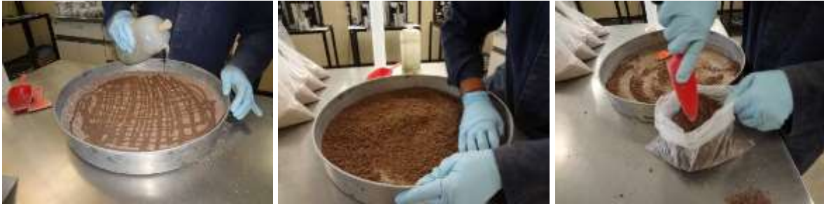
Figura 2.15. Proceso de humectación, mezclado y curado de muestras.
