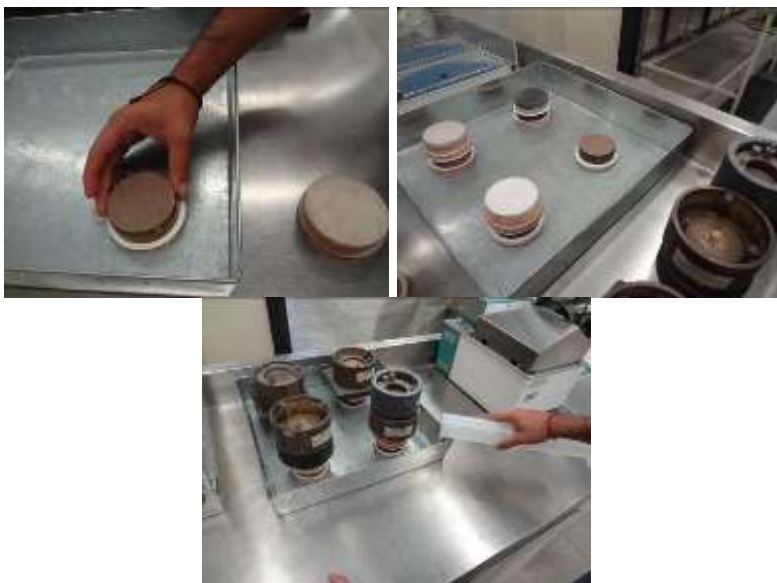
Figura 2.38. Proceso de saturación del espécimen de prueba.
