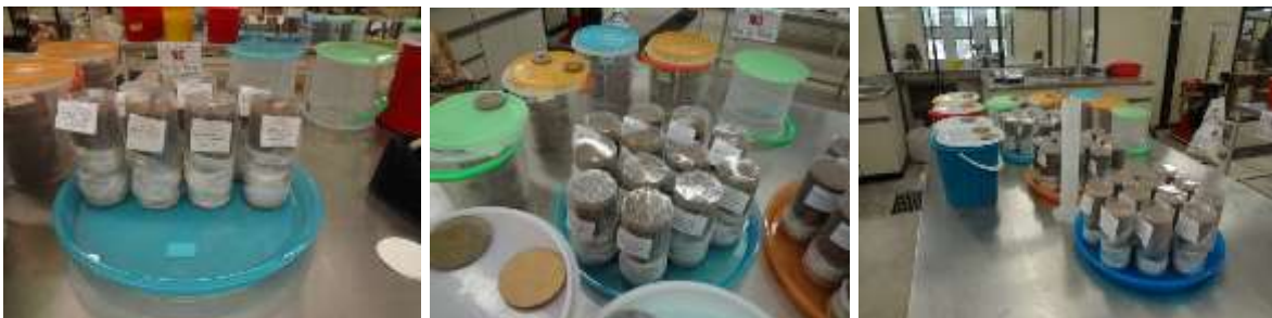
Figura 2.25. Acondicionamiento de especímenes (trayectoria de humedecimiento).
