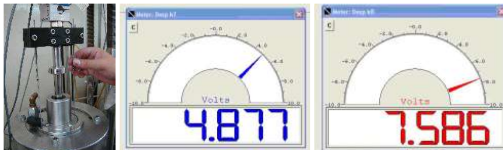
Figura 2.31. Ajuste de los transductores de desplazamiento.
