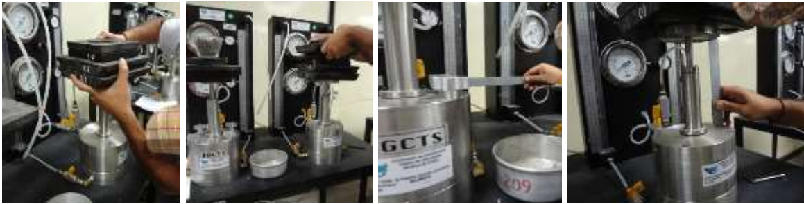
Figura 2.40. Colocación de pesos en la placa de carga y toma de lecturas iniciales.
