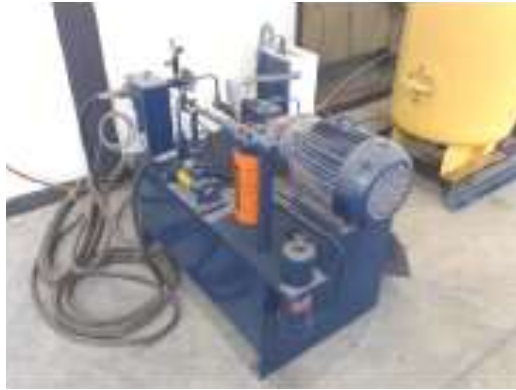
Figura 2.4. Sistema hidráulico para la aplicación de cargas.
