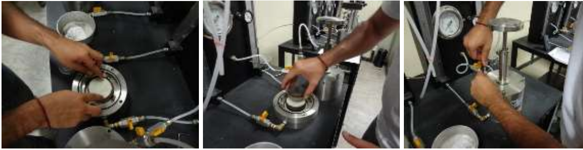
Figura 2.39. Colocación de papel filtro y ensamble de la celda de presión.
