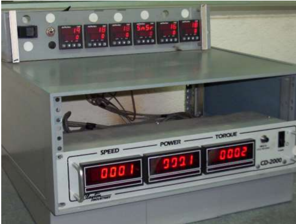
Figura 3.5 Indicadores de dinamómetro y los termopares
