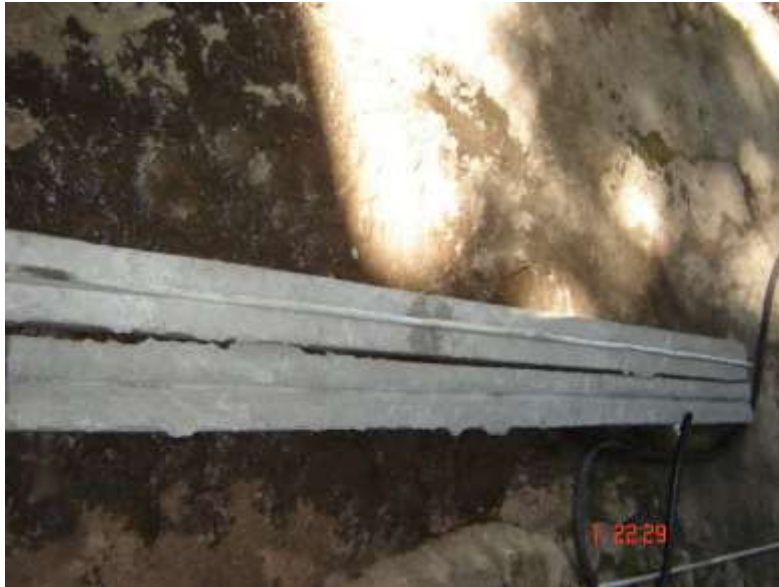
Figura 3.10 Colocación de la manguera de plástico sobre la muestra de concreto
