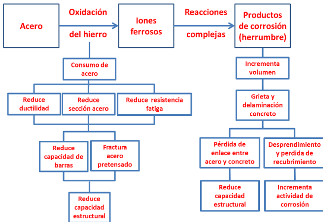
Figura 2.1 Mecanismo de deterioro para corrosión del acero en concreto
