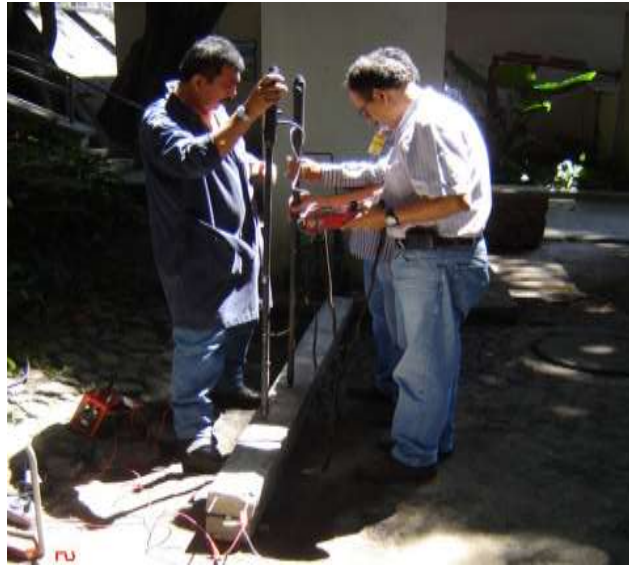
Figura 4.2 Ensayos de la técnica gradiente de voltaje en corriente directa (DCVG) con el equipo en el Instituto de Investigaciones Eléctricas
