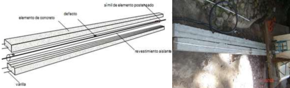
Figura 3.1 Muestra de la sección de concreto que simula un elemento postensado con manguera de plástico
